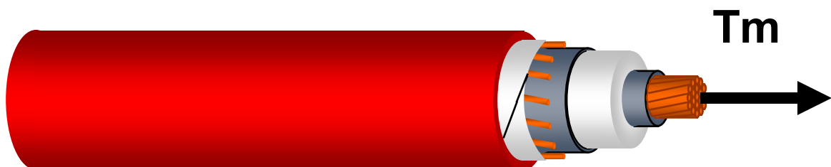
Figura 53. Ilustración de tensión máxima de jalado
