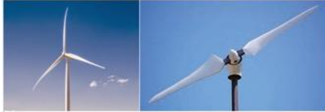
Ilustración 1.21: Aerogenerador de 3 y 2 palas respectivamente.
