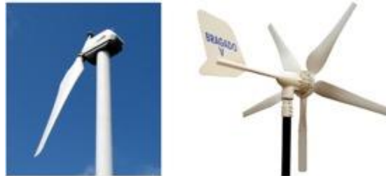
Ilustración 1.22: Aerogenerador de una pala y multipalas respectivamente.
