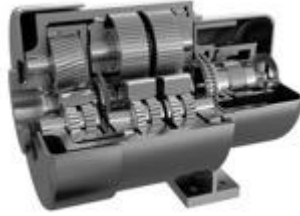
Ilustración 1.26: Caja de engranajes.
