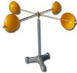
Ilustración 1.6: Anemómetro de rotación.
