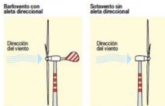
Ilustración 1.20: Aerogeneradores de eje horizontal.
