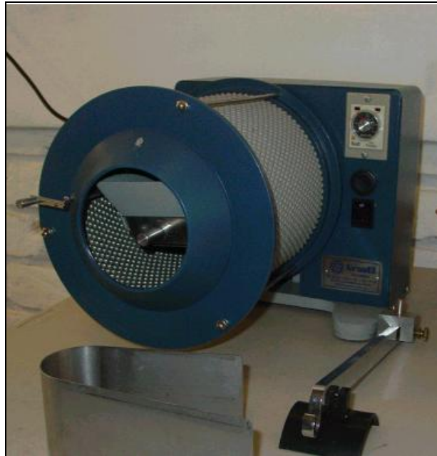
Fig. 2.15 Clasificador cilíndrico para granos Planta Piloto Atiocoyo Norte (2008)
