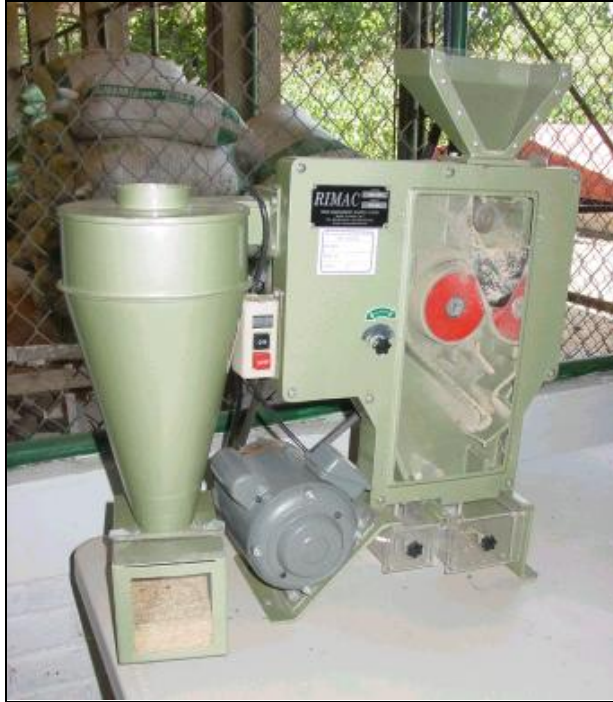
Fig. 2.12 Descascarillador de arroz granza Planta Piloto Atiocoyo Norte (2008)
