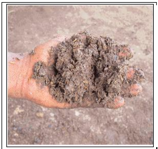
Fig. D-5 Realización de prueba de humedad.
