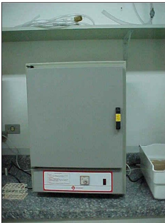
Fig. 2.3 Estufa utilizada para el secado de la granza (UES 2008)
