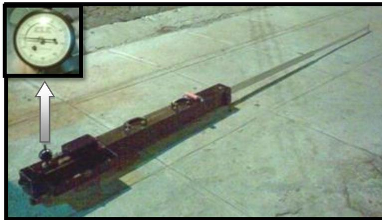
Figura 3.13. - Viga Benkelman y Micrómetro Dial
