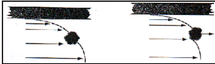
FIGURA 4.1: FLUJO DE UNA PARTÍCULA SOMETIDA A UN ESFUERZO DE CORTE
