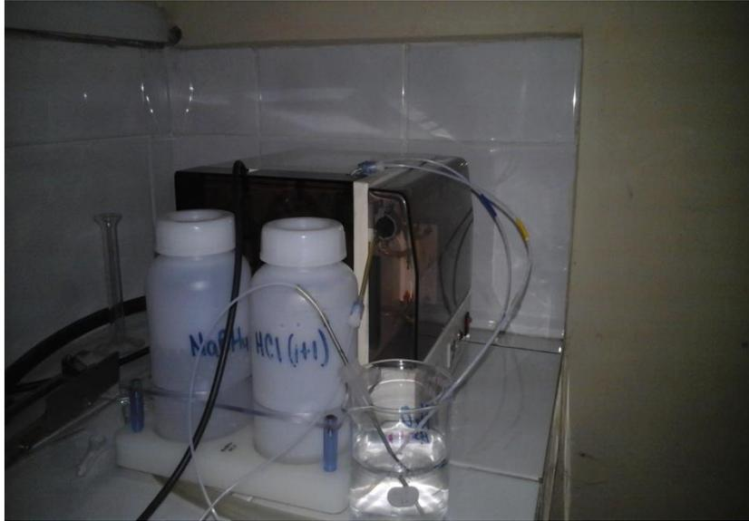
**Figura N°12.** Disolución de Borohidruro de Sodio en medio Acido (HCl) para conseguir la generacion del hidruro.
