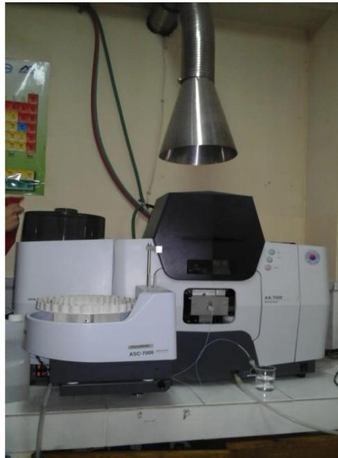
**Figura N°9.** Espectrofotómetro de Absorción Atómica (EAA) para Llama (FAAS) y Horno de Grafito (GFAAS).
