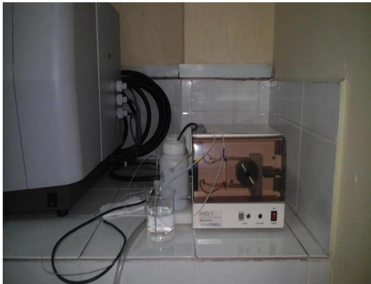
**Figura N°11.** Sistema Generador de Hidruros (GHAAS)
