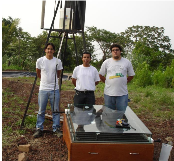
Figura 3.4-2: Pasteurizador Solar Montado Antes de Comenzar la Etapa Experimental
