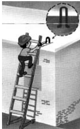
Fig. 5.14 Escalera apoyada en la parte superior
