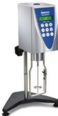
Figura N° 9. Equipo empleado en la determinación de la viscosidad, viscosímetro marca BROOKFIELD DV-I Prime). (27)
