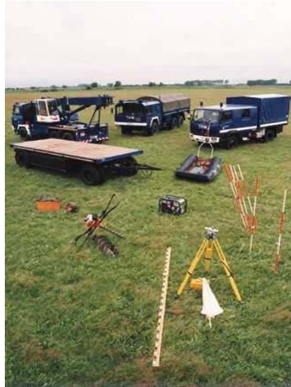
Figura 4.8 Equipo para el montaje de puentes metálicos modulares.
