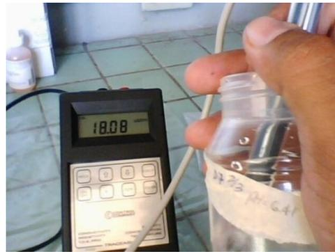
**Figura 4. 6** Equipo para la determinación de Conductividad y Resistividad y STD
