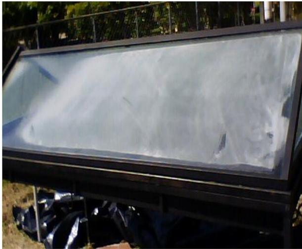
**Figura 3.17** Proceso de evaporación del agua de bandeja, lo cual se manifiesta de manera visual generando opacidad en la cubierta de vidrio
