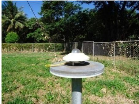
**Figura 4. 1** Solarímetro para recopilar datos de radiación solar, de la estación meteorológica del Observatorio Ambiental, Ubicado en la Universidad de El Salvador
