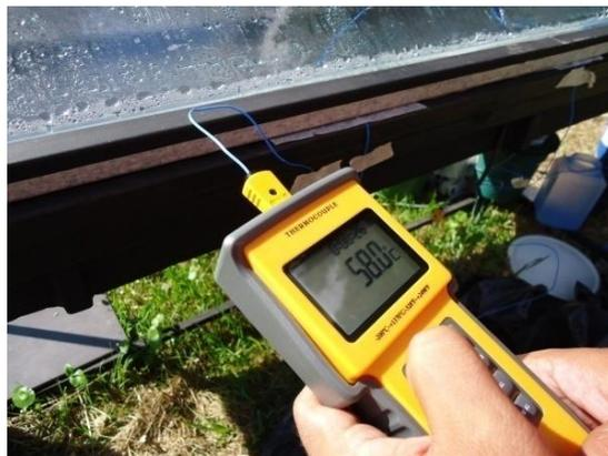
**Figura 4. 3** Medición de temperaturas con ayuda de una termocupla
