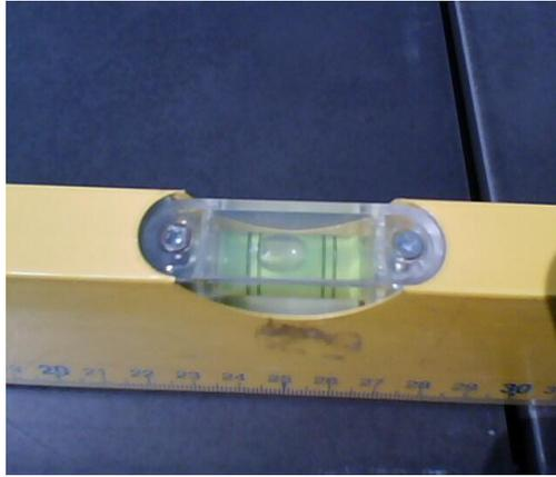
**Figura 3. 9** Equipo utilizado para verificación de nivel en la estructura de la bandeja, de tal manera que el agua se distribuya uniformemente sobre la misma
