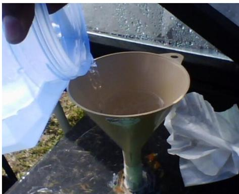
**Figura 3. 13** Adición de materia prima (agua de grifo) al sistema de destilación
