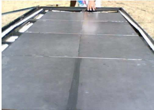
**Figura 3. 12** Pileta de cerámica (Evaporador)
