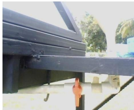
**Figura 3. 14** Tubería que transporta el agua alimentada al sistema hacia la bandeja de cerámica
