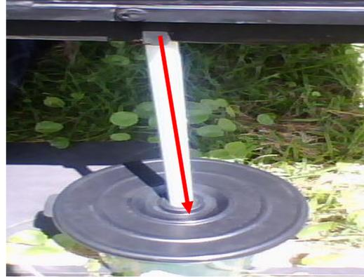
**Figura 3.20** Tubería de transporte de agua destilada y recipiente colector
