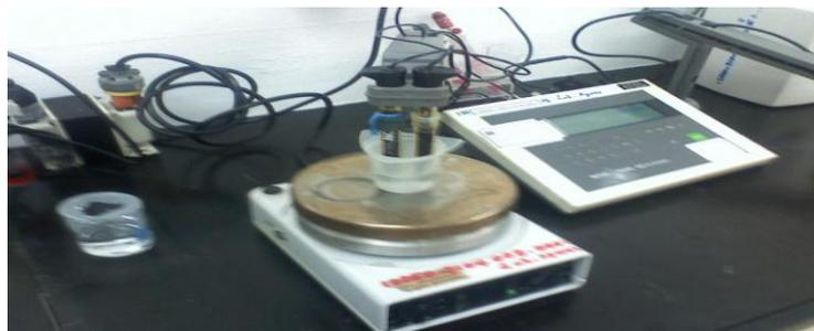
Figura N°5: Aparato Mettler Toledo 355 y electrodos de fluoruros Thermo Orión 96-09.
