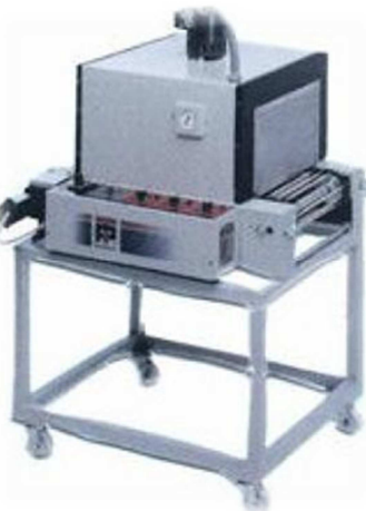
Figura 6-5. Túnel de calor o de termoencogimiento.
