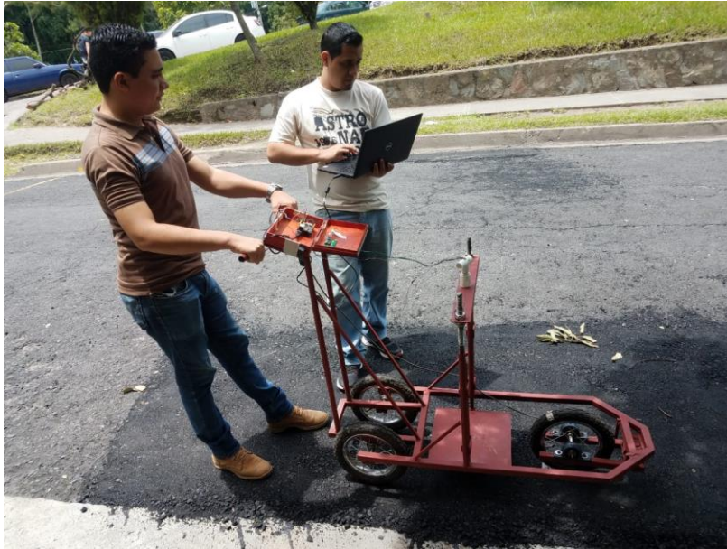
Calibración de la cantidad de pulsos en el encoder equivalentes a 50 cm Fuente: Elaboración Propia
