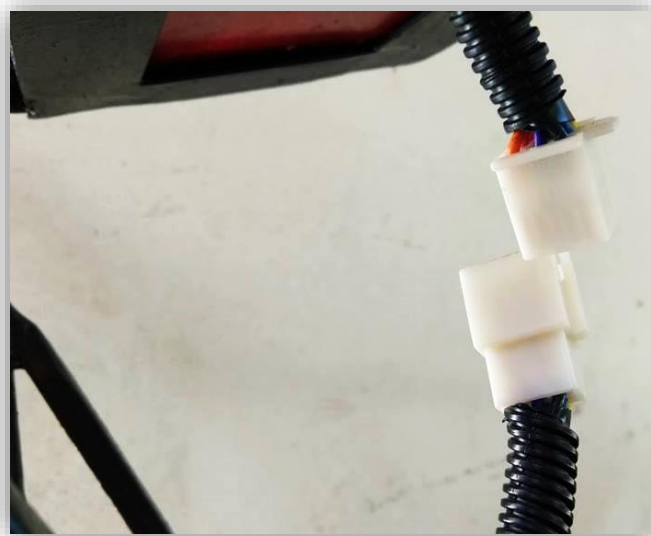
Figura 3 - 46 Conexión caja de operación con cableado principal. Fuente: Elaboración Propia
