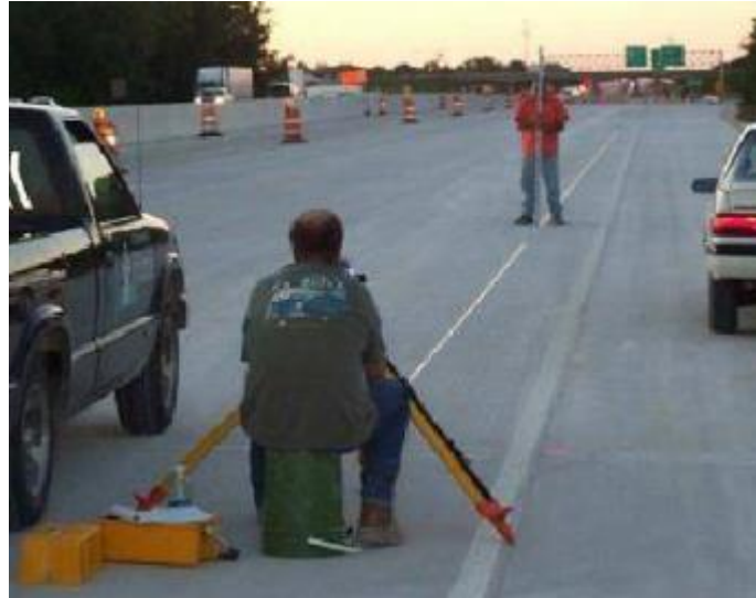
Figura 2 - 7 Medición de los perfiles con nivel y mira. Fuente: Informe de Rugosidad en pavimentos Pereyra Herrera.
