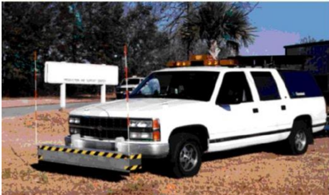
Figura 2 - 9 Perfilómetro del tipo RSP, para la medición del IRI. Fuente: Informe de Rugosidad en pavimentos Pereyra Herrera.
