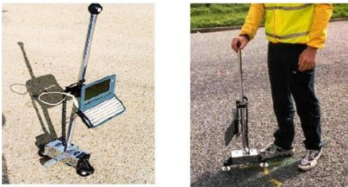
Figura 2 - 8 Empleo del Face Dipstick en la medición de rugosidad. Fuente: Informe de Rugosidad en pavimentos Pereyra Herrera.
