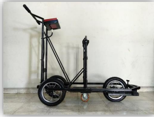
Figura 3 - 33 Vista de Perfilómetro digital finalizado. Fuente: Elaboración Propia
