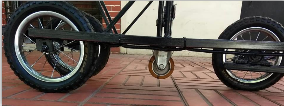
Ruedas del nuevo perfilómetro del mismo diámetro y a una 32PSI cada una. Fuente: Elaboración Propia
