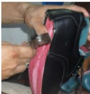
Ilustración 79 Utilización de tenaza en la elaboración de calzado por un micro productor en Mejicanos, San Salvador
