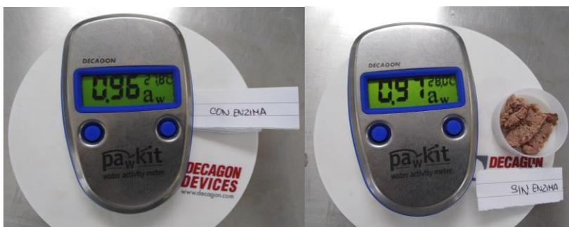
Figura 3.4. Mediciones de Actividad de Agua. Muestra de carne con enzima Transglutaminasa (izquierda) y carne sin enzima Transglutaminasa (derecha)
