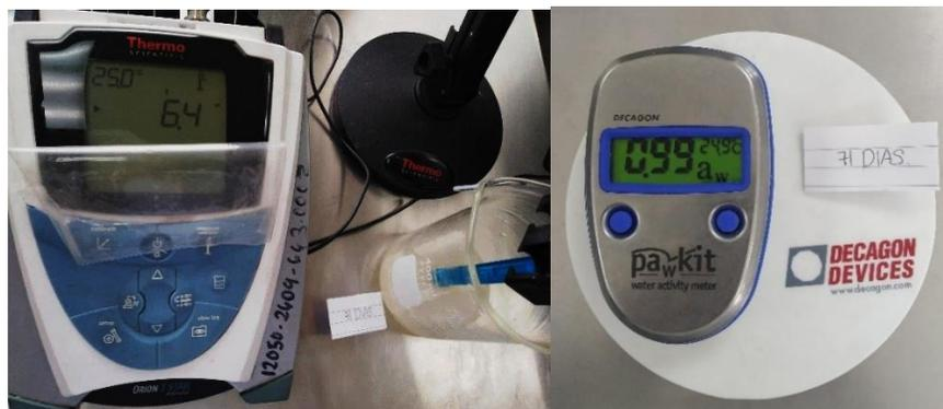
Figura 3.13. Medición experimental de pH (Izquierda) y prueba de actividad de agua (derecha).
