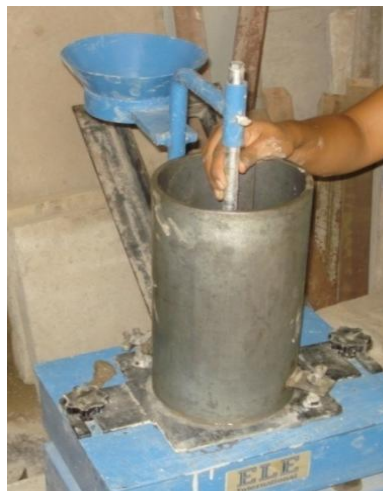
FIGURA N° 3.19: CENTRADO DE LA SOBRECARGA EN EL MOLDE
