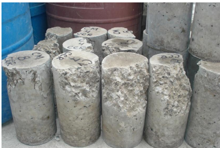
FIGURA N° 5.23: TIPOS DE FALLA EN LOS CILINDROS ENSAYADOS
