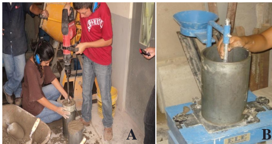
Figura (A): Elaboración de cilindros con el Martillo Vibrocompactador. (B) Cilindros elaborados con la Mesa Vibratoria Fuente: Fotografías tomadas en el Instituto Salvadoreño del Cemento y el Concreto (ISCYC)
