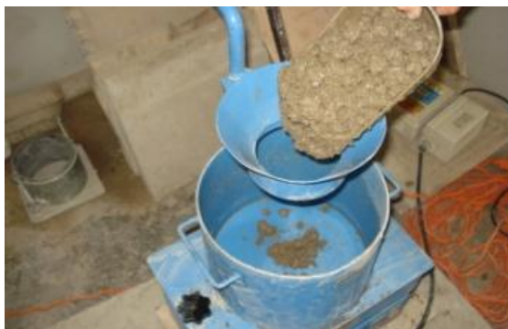
FIGURA N° 3.11: COLOCACIÓN DE CONCRETO PARA MEDIR SU CONSISTENCIA
