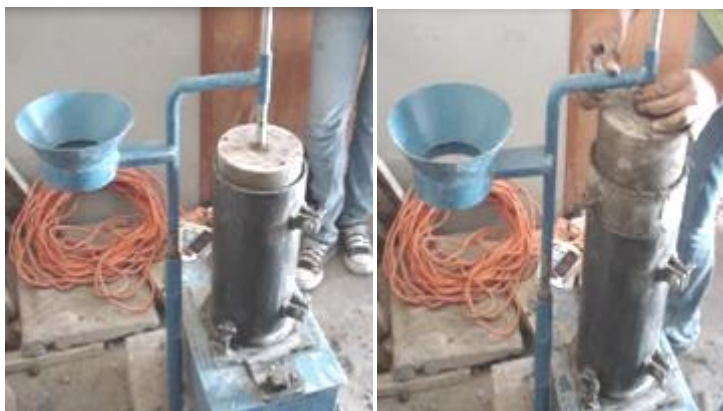
FIGURA N° 3.21: LLENADO DEL MOLDE PARA LA SEGUNDA Y TERCERA CAPA
