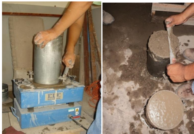
FIGURA N° 3.22: RETIRADO DEL ESPÉCIMEN DE MESA VIBRATORIA Y REALIZACIÓN DE ACABADO EN LA SUPERFICIE SUPERIOR.
