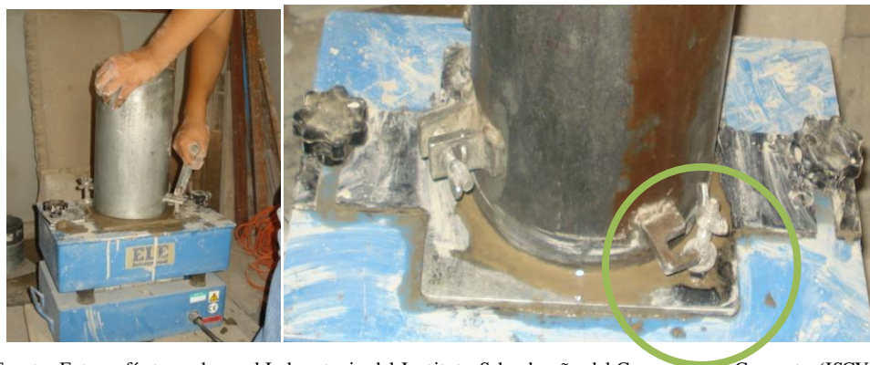
FIGURA N° 5.13: MOLDE CILÍNDRICO EN LA MESA VIBRATORIA, DESENMOLDADO PARA COLOCARLE SU PLACA BASE
