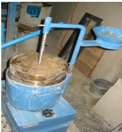
FIGURA N° 3.12: COLOCACIÓN DE SOBRECARGA
