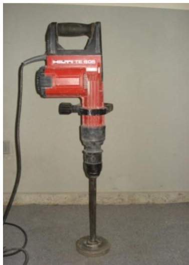
FIGURA N° 3.16: MARTILLO VIBROCOMPACTADOR (HILTI)
