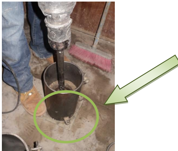
FIGURA N° 5.14: LLENADO DE MOLDE CILÍNDRICO CON EL MARTILLO VIBROCOMPACTADOR, CON SU PLACA BASE RESPECTIVA
