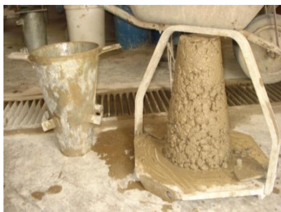
FIGURA N° 5.1: REVENIMIENTO CERO EN LA MEZCLA DE CCR
