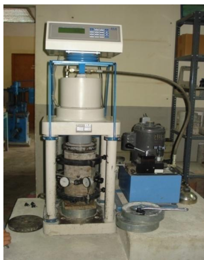
FIGURA N° 3.26: EQUIPO UTILIZADO EN EL ENSAYO DE MÓDULO DE ELASTICIDAD ESTÁTICO Y RELACIÓN DE POISSON.
