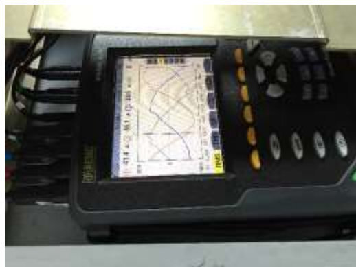
Figura 3.4-8 Analizador de redes, marca AEMC prestado por la Escuela de ingeniería eléctrica de la universidad de El Salvador. Fuente: propia. 2018
