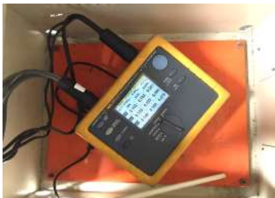
Figura 3.4-7 Analizador de redes, marca Fluke prestado por la unidad de desarrollo físico de la universidad de El Salvador. Fuente: propia. 2018
