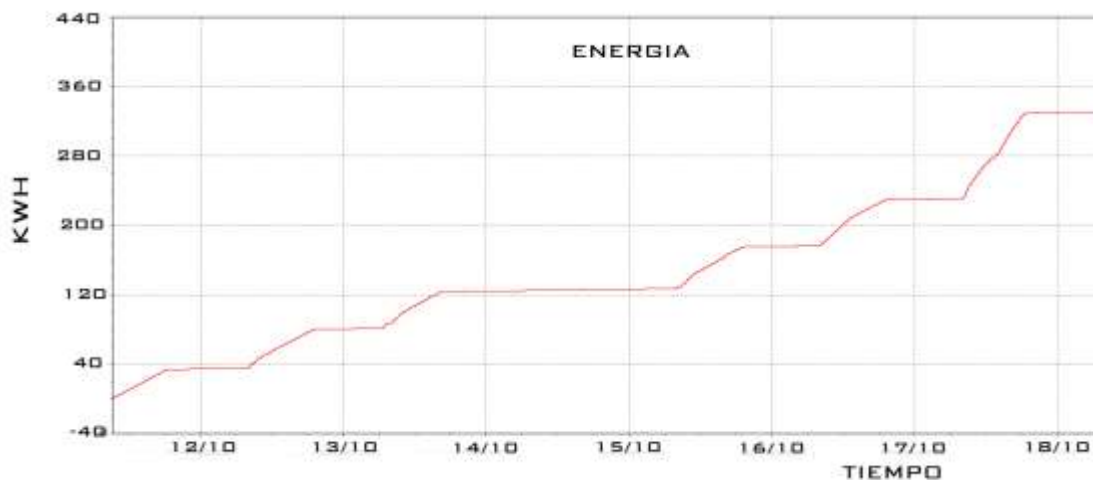
Figura 3.6-2 Historial de consumo de energía de los equipos de aire acondicionado en el segundo nivel del edificio de postgrados; Fuente: Propia
