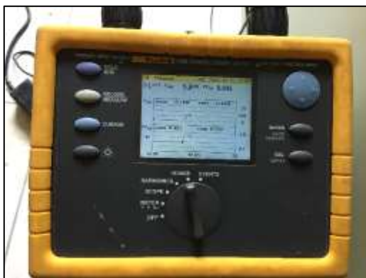
Figura 3.6-8 Analizador de redes conectado y registrando datos. Fuente: Propia
