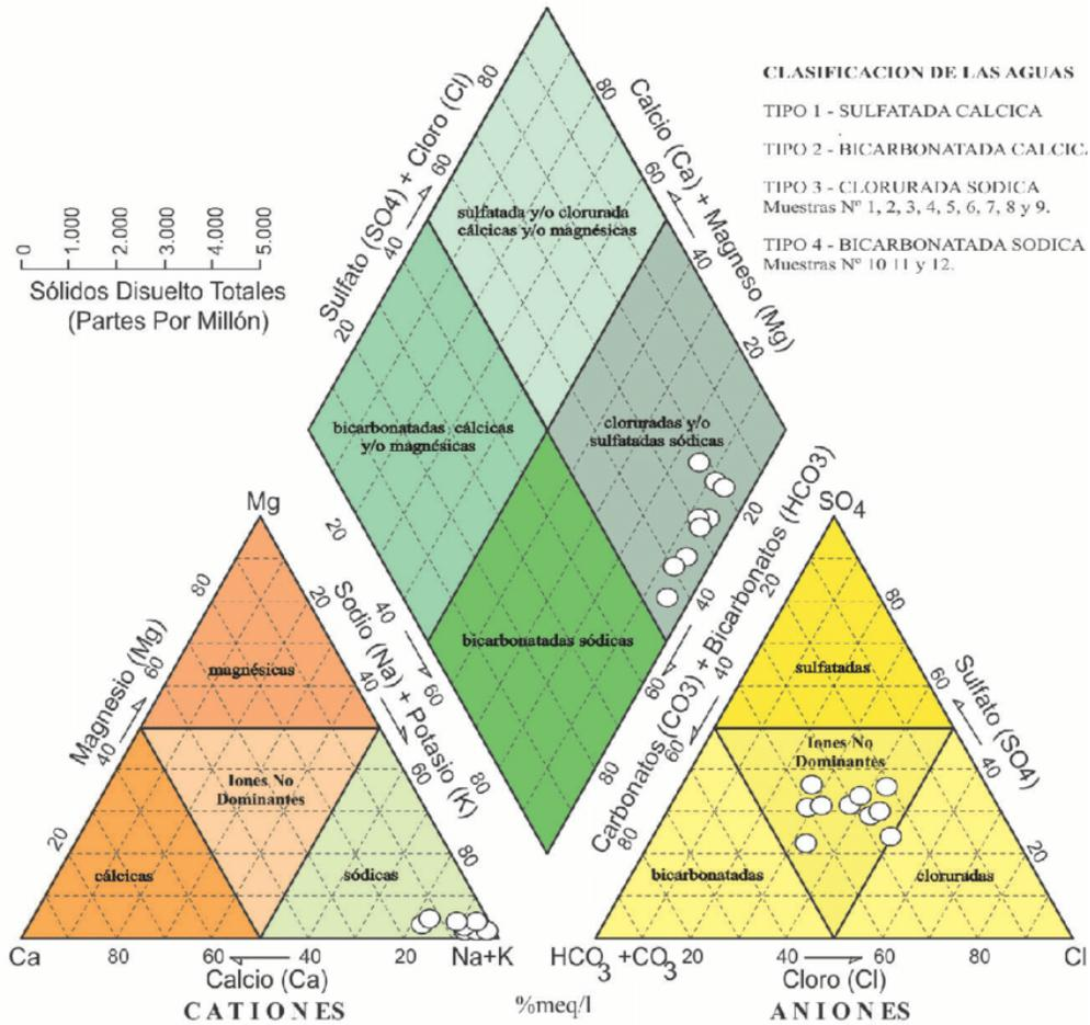
Figura 3: Diagrama de PIPER. (2019). [Esquema]. Fuente: (emaze)
