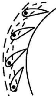
Figura. 1.7. Álabes en posición abierta (líneas llenas) y en posición cerrada (líneas punteadas)
