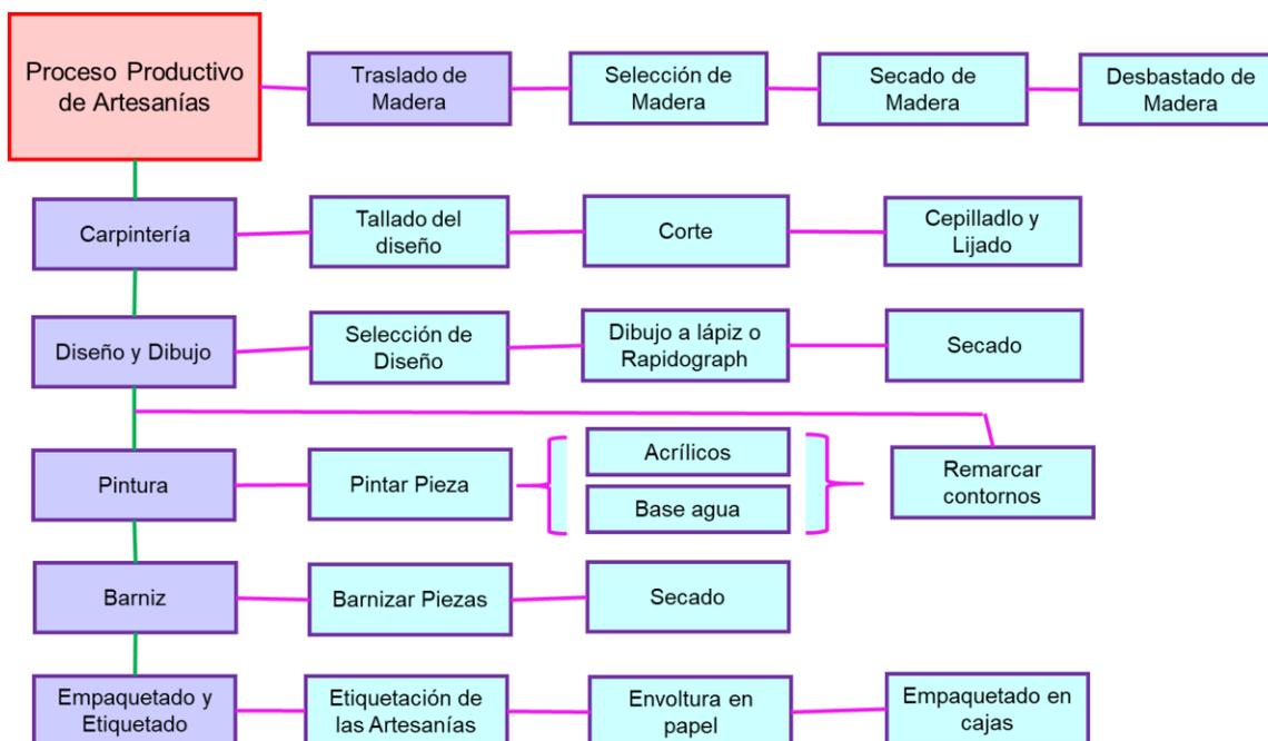
**Figura 2** Proceso de Producción de las Artesanías de Madera
