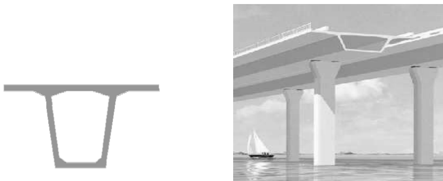
Figura 2.10 Sección tipo cajón.
