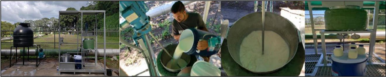
Figura 31: Prototipo de pasteurizador de leche y proceso de pasteurización en un campo geotérmico de El Salvador. Modificado de (Chavarría, 2019).
