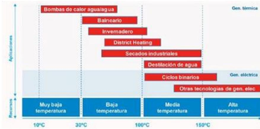
Figura 9: Aplicación y clasificación de los recursos geotérmicos en base a su temperatura (°C). Tomado de Castillo (2019).
