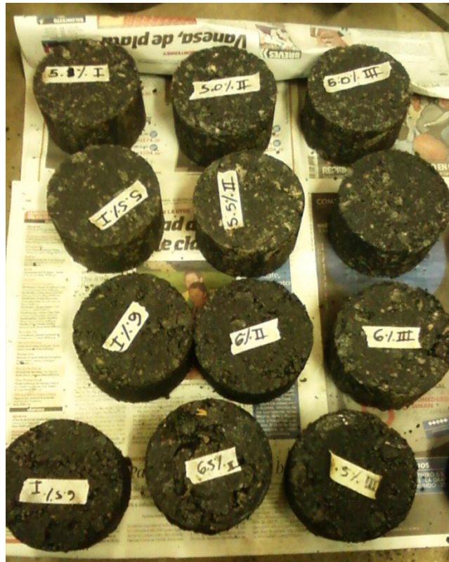
Figura 4.7. Elaboración de briquetas con distintos contenidos de asfalto residual.
