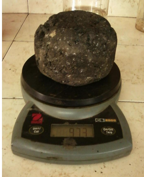
Figura 5.13 Pesado de briquetas después de ser ensayadas por Cántabro.
