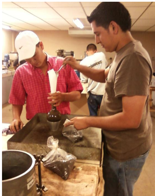
Figura 4.5. Realización del ensayo de gravedad específica al agregado fino.
