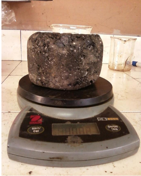
Figura 5.13 Pesado de briquetas después de ser ensayadas por Cántabro.
