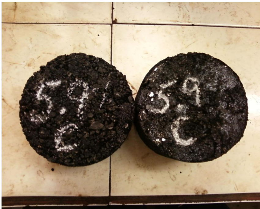
Figura 5.12 Briquetas con contenido óptimo de asfalto para ensayo Cántabro.
