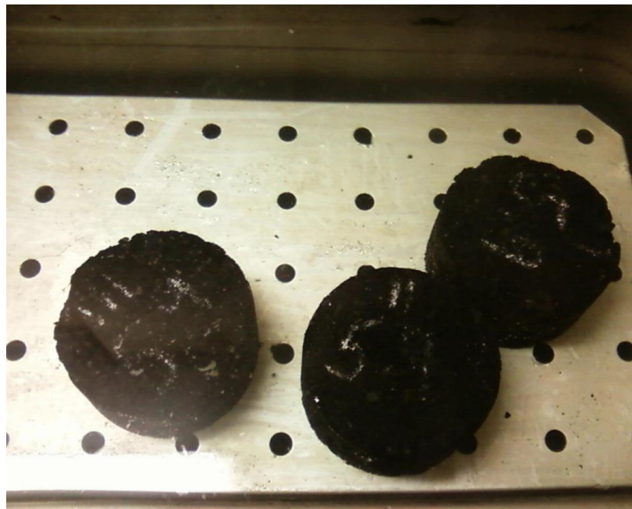
Figura 5.15 Briquetas en baño de María a 60 °C
