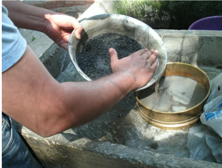
Figura 4.4. Lavado de agregados para determinar granulometría por vía húmeda.
