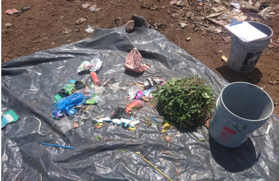
Figura 3.4.4: Separación de desechos para clasificación sobre carpeta.
