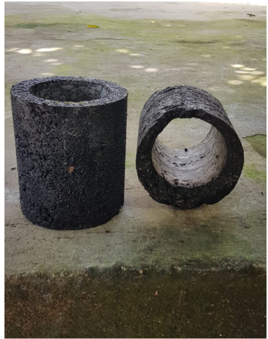
Ilustración 3.15 – Extracción de corazón
