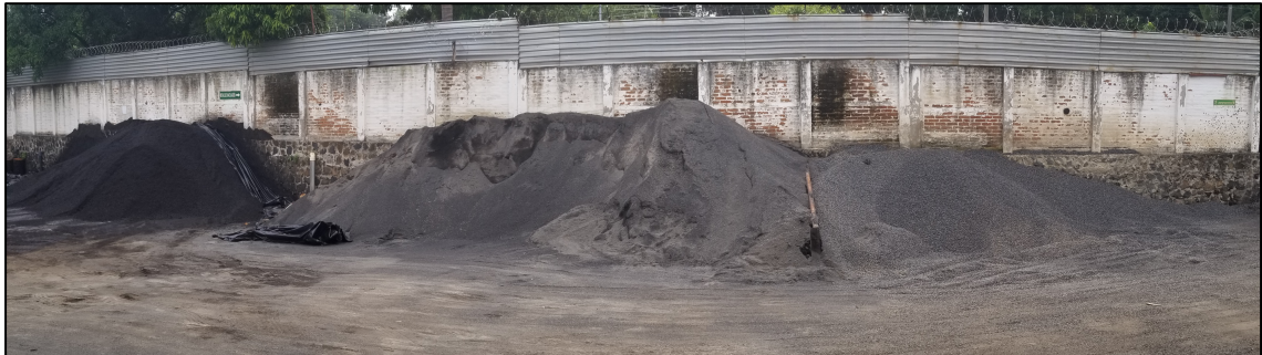
Ilustración 3.1 – Acopio de agregados ASFALCA S.A. de C.V.
