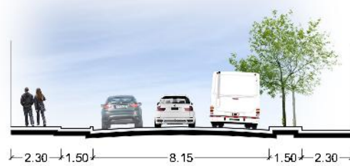
Vía: 1° Calle Poniente Tipo de Vía: Vía de Circulación Mayor Material de Rodaje: Asfalto Recorrido: De Oriente a Poniente Sentido de Vía: Sentido único
