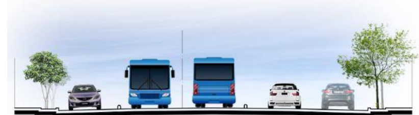
Esquema 25: Sección tipo del Sistema Integrado de Transporte del Área Metropolitana de San Salvador (SITRAMSS) en el área de la Zona Médica.
