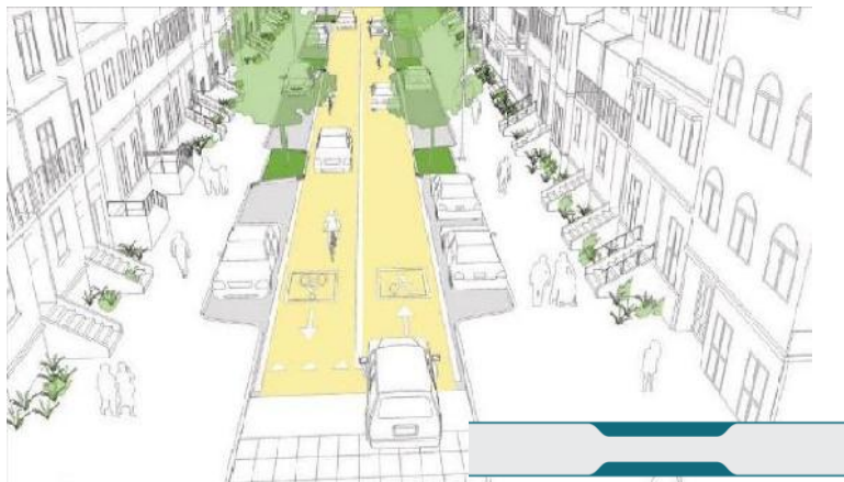
Imagen 46: Alternativas de reducción de ancho de carril, National Association of city transportation officials (NACTO).
