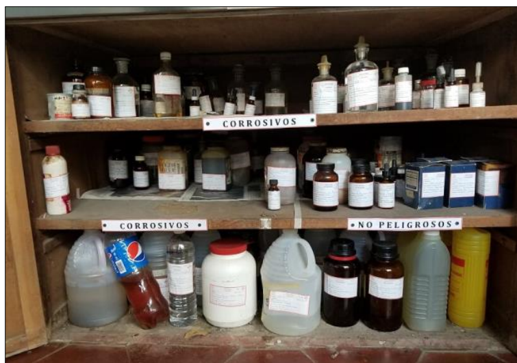
Figura 2.41 Área de almacenamiento para residuos y desechos corrosivos (Interior) del laboratorio académico de Ingeniería Química
