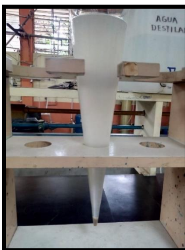
Figura 2.7 Medición de sólidos sedimentables de las aguas grises.
