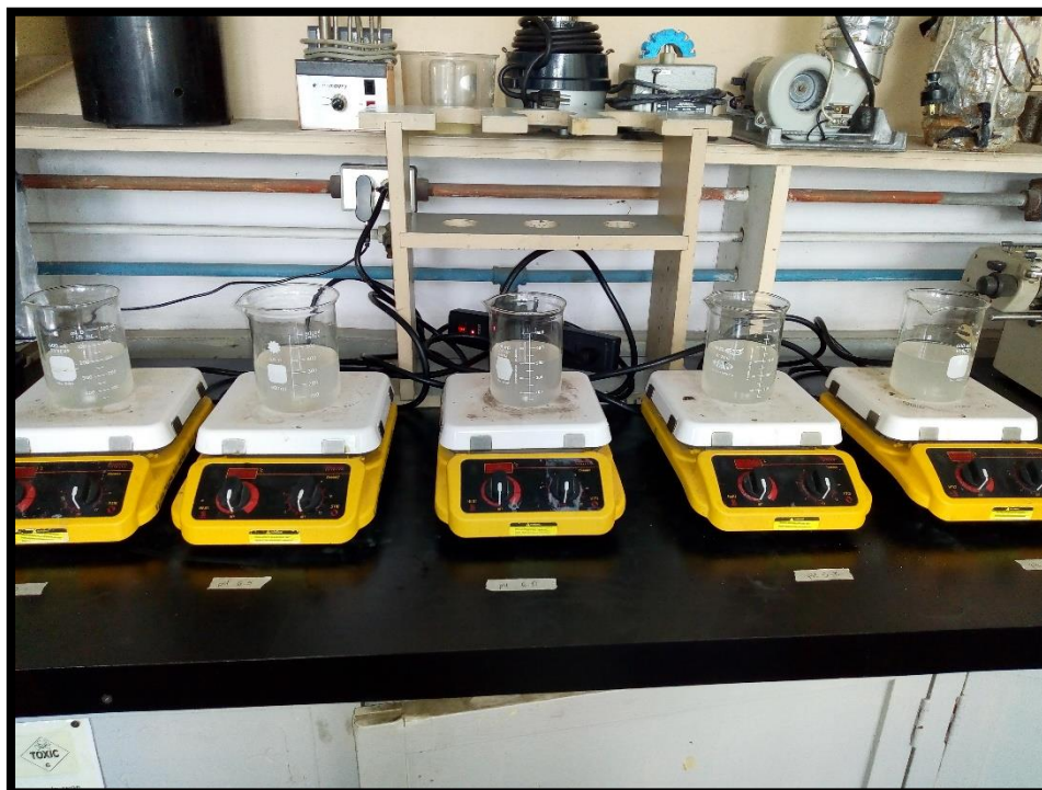
Figura 9.1 Montaje de sistema de agitación.
