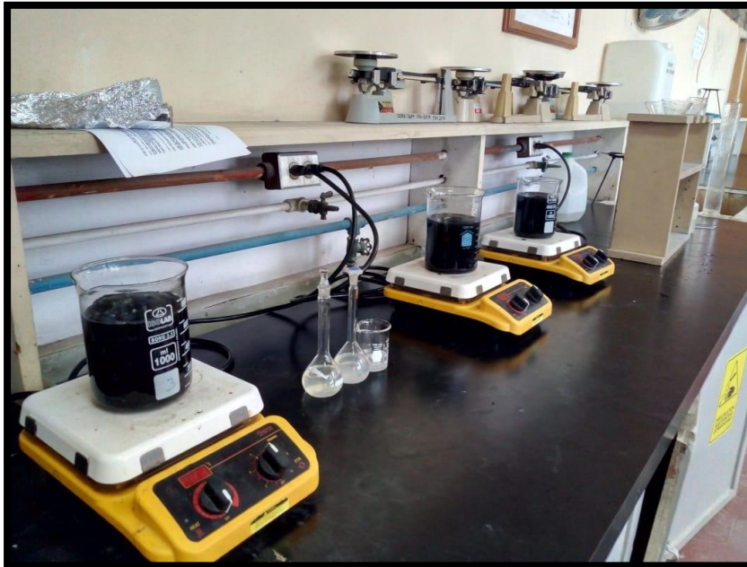
Figura 10.3 Aplicación y agitación del carbón activado al agua tratada.
