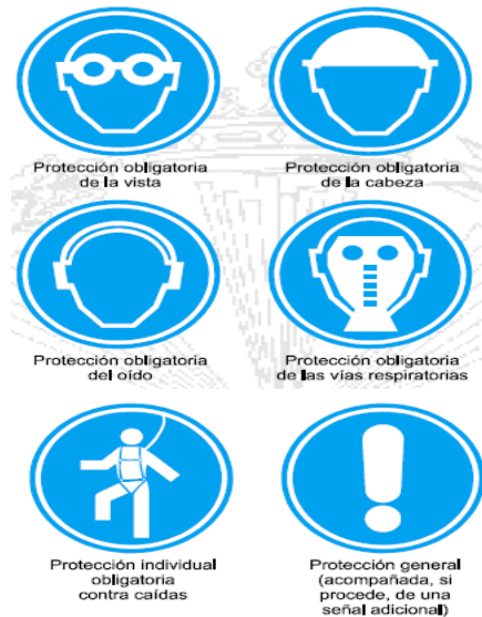
Figura 4.22: Esquema de señalización de obligación.
