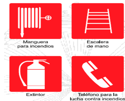
Figura 4.24: Esquema de señalización de equipos contra incendio
