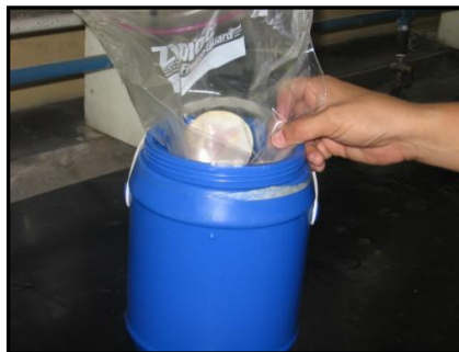
Figura 5.17: Los precipitados de Cromato de plata y Cloruro de plata se colocan en una bolsa ziploc y luego en un recipiente de polietileno de alta densidad.
