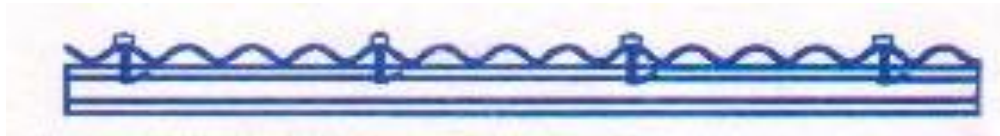
Fig. 173. Ubicación de tramos galvanizados para fijación de lámina a polín.
