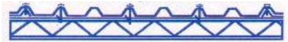
Fig. 170. Ubicación de tramos y tornillos de fijación.
