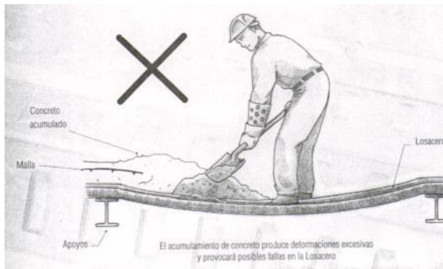
Fig. 147. Forma incorrecta de realizar el colado de la losacero.
