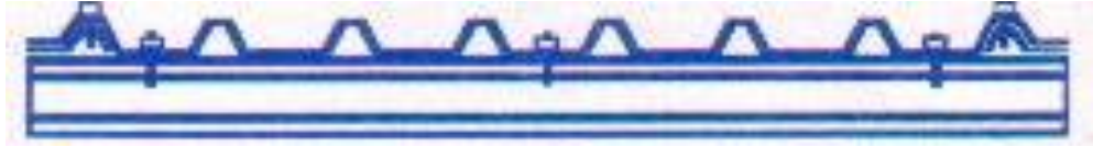
Fig. 174. Fijación de lámina a polín c.
