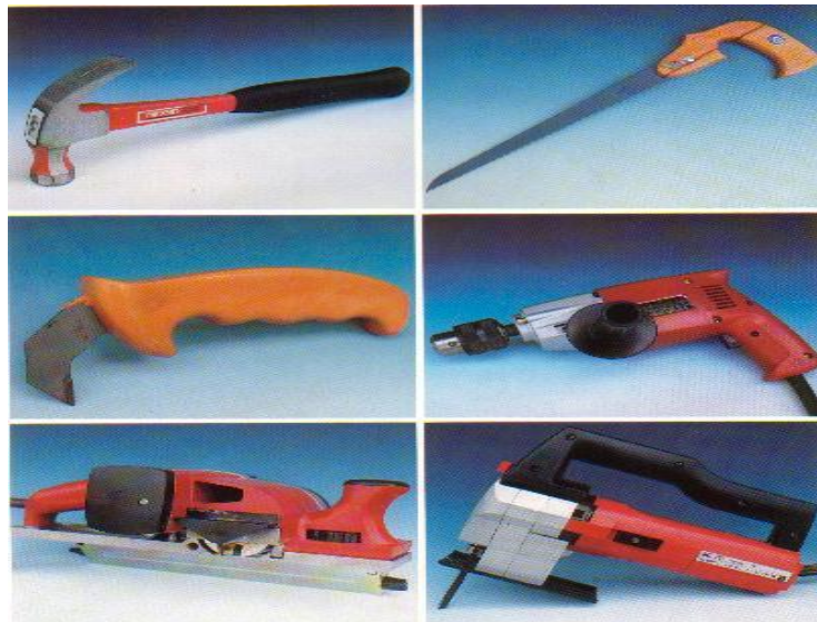
Fig. 37. Equipo y herramientas utilizado para la instalación de láminas PLYCEM
