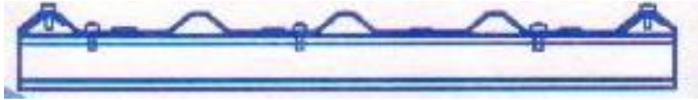
Fig. 176. Colocación tornillos autorroscantes y tornillos cónicos para fijación lámina-polín.
