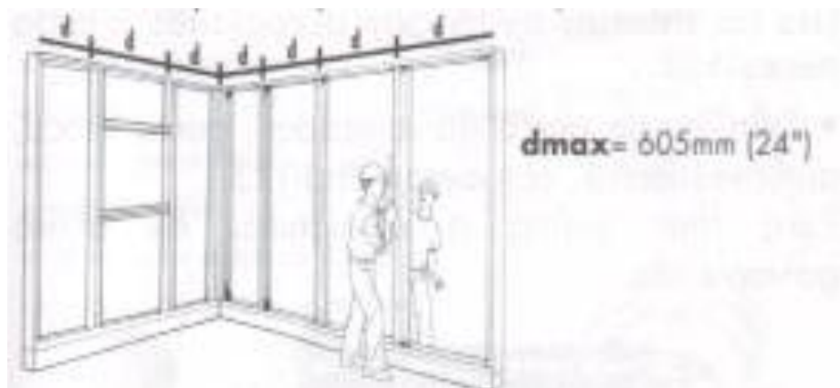
Fig. 59. Estructura de acero galvanizado.
