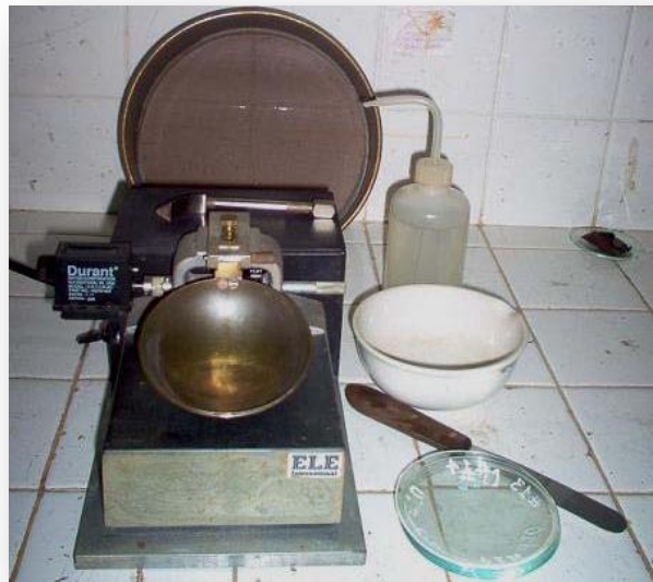
Figura. 2.11 Equipo utilizado durante el ensayo de límite líquido.
