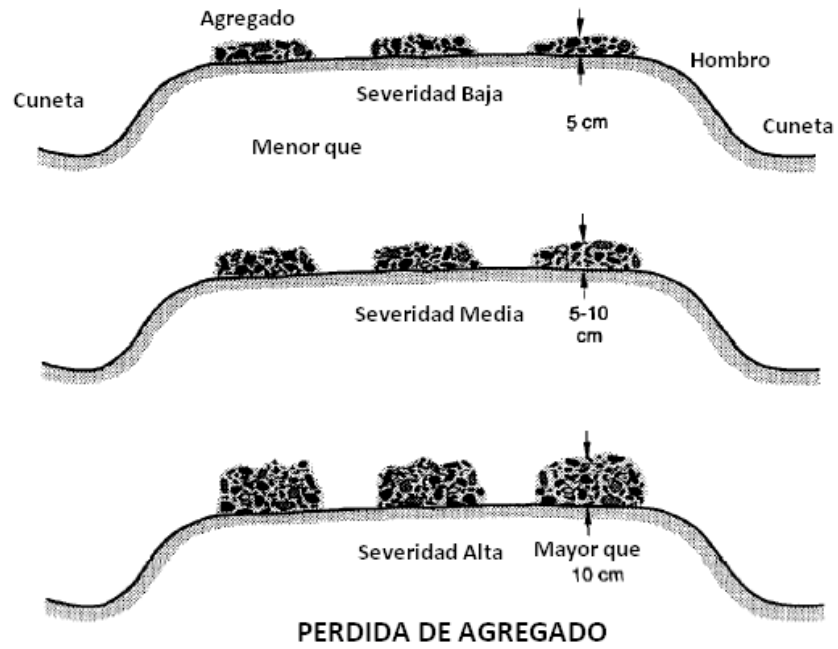
FIGURA 6.8 PERDIDA DE AGREGADO.
