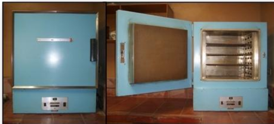
Figura 2.8. Horno para el secado del agregado grueso y fino.
