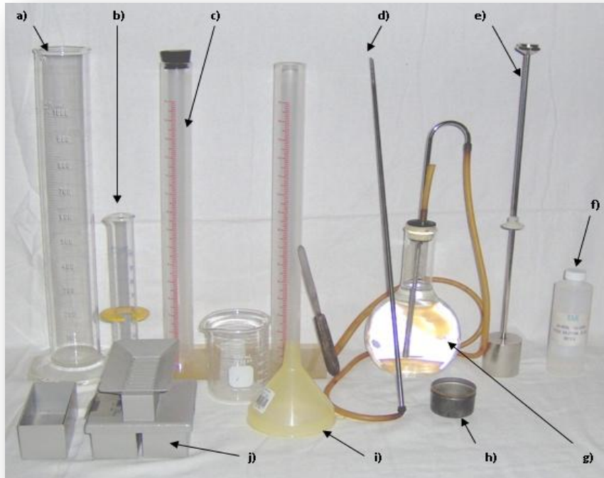
Figura. 2.13 Equipo para realizar ensayo de equivalente de arena
