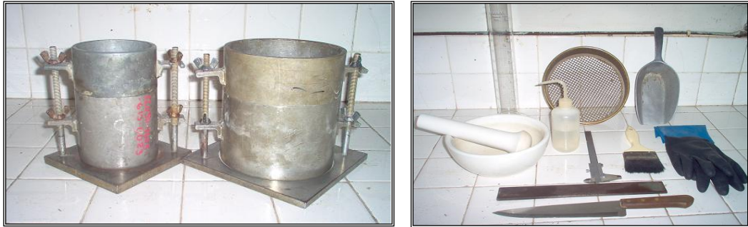
Figura. 2.22 y 2.23 Equipo para la realización de ensayo de Proctor
