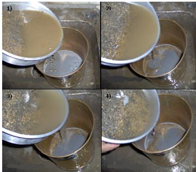
Figura 2.10. Decantación de agregados en tamiz n° 200 hasta que el agua sale limpia.
