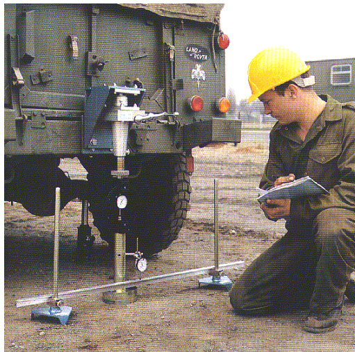
Figura 2.29.Desarrollo del ensayo CBR de campo.
