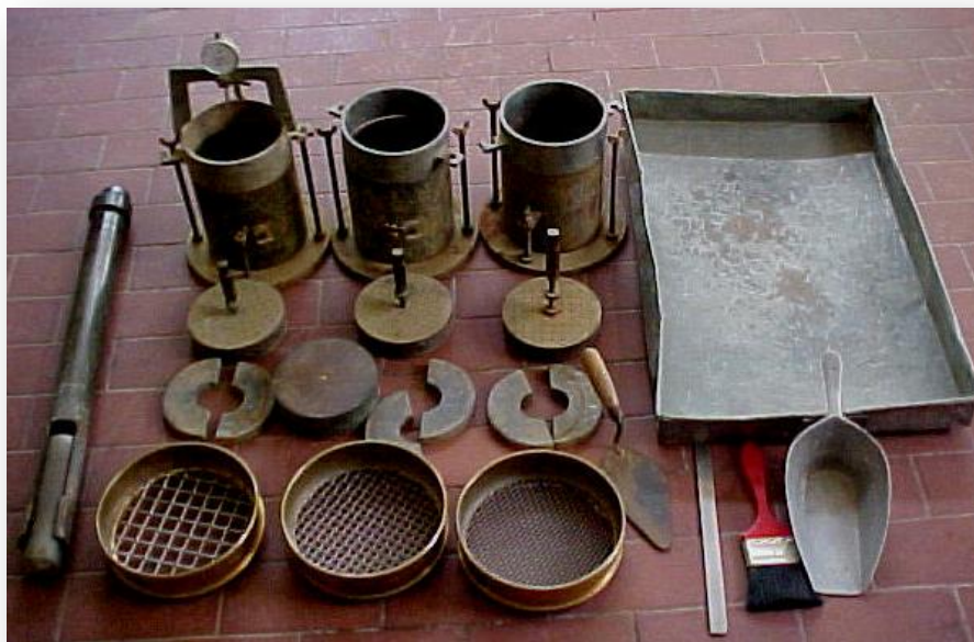
Figura. 2.25 Equipo utilizado para la realización del ensayo de CBR
