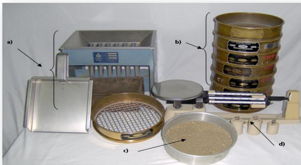
Figura 2.3. Equipo para ensayo de tamizado: a) Cuarteador de agregado fino b) Juego de tamices c) Muestra a ensayar d) Balanza de 0.1 g de precisión
