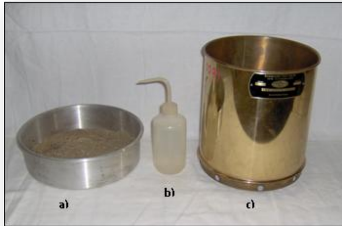
Figura 2.7. a) Contenedor de muestra, b) Piseta para devolver el material retenido en el tamiz, c) Tamiz para decantación de muestra.
