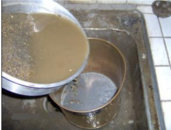
Figura 2.9. Agua conteniendo material fino suspendido, siendo vertido en el tamiz N° 200.
