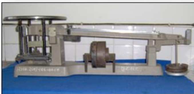
Figura 2.2 Balanza para muestras de agregado grueso de 20 Kg, con precisión de 1g.
