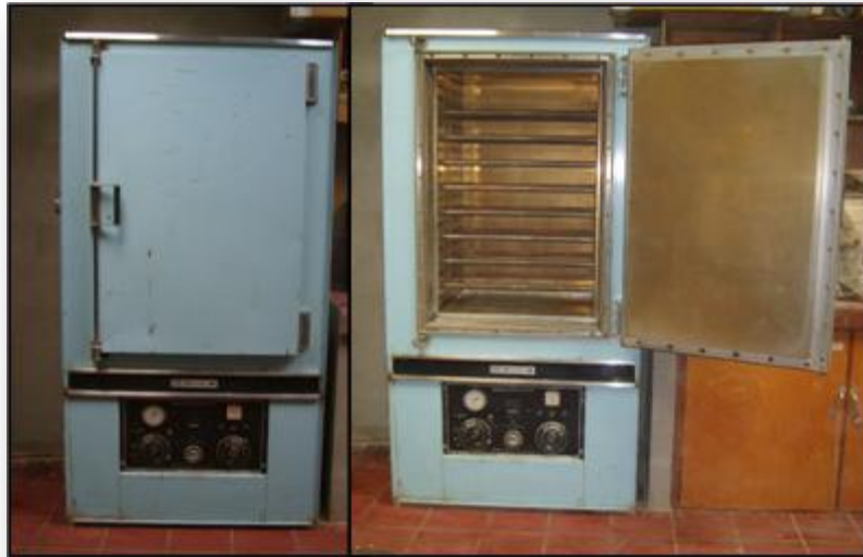
Figura 2.5. Horno para el secado de agregados grueso y fino.
