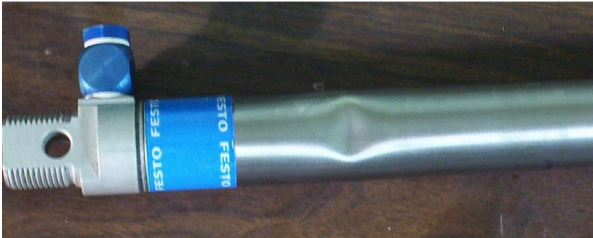
Figura 3.25. Una mejor vista del daño a la pieza del sistema neumático de puesta a tierra.
