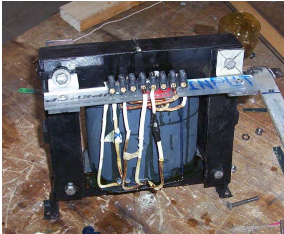
Figura 3. Transformador terminado y barnizado
