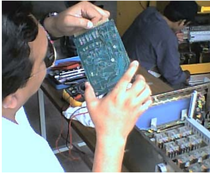
Figura 3.22. Una pequeña revisión y medición de los elementos que contiene la tarjeta, de la unidad de servicios en el panel de control. Se observo que a la tarjeta tenia una pista quemada debido a un corto circuito.
