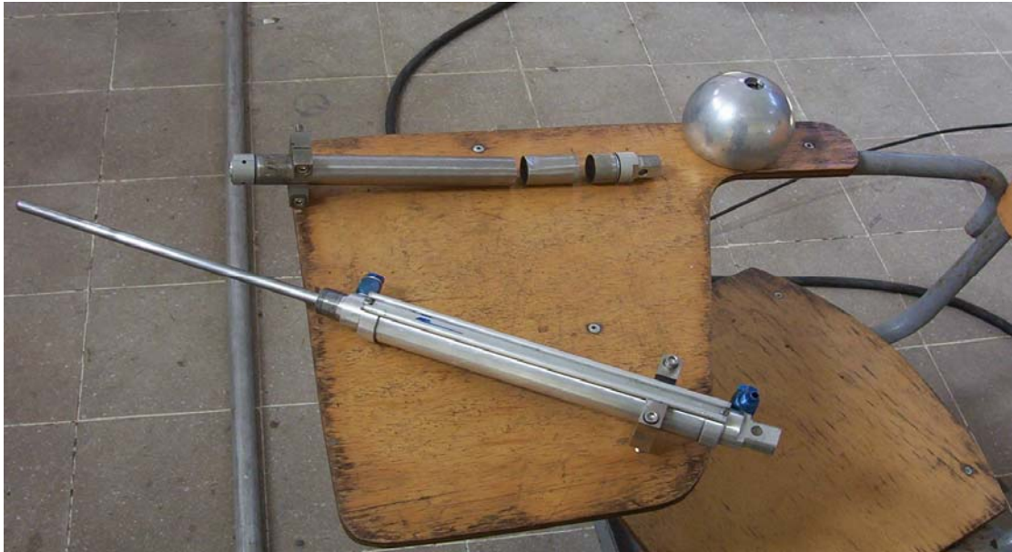
Figura 3.26. Pieza construida del sistema neumático de puesta a tierra.
