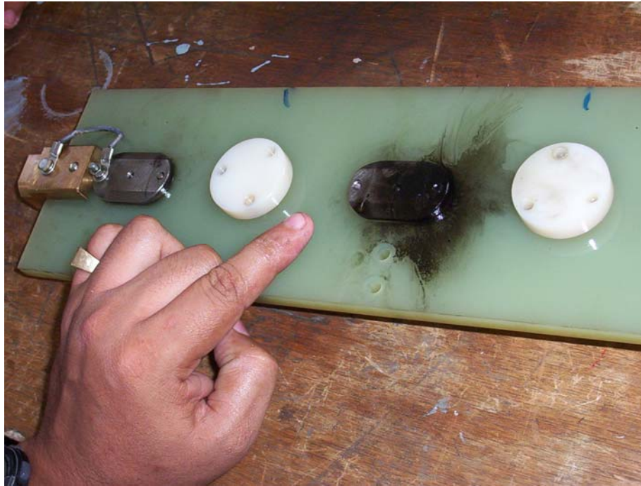
Figura 3.37. Puntos de contacto quemados
