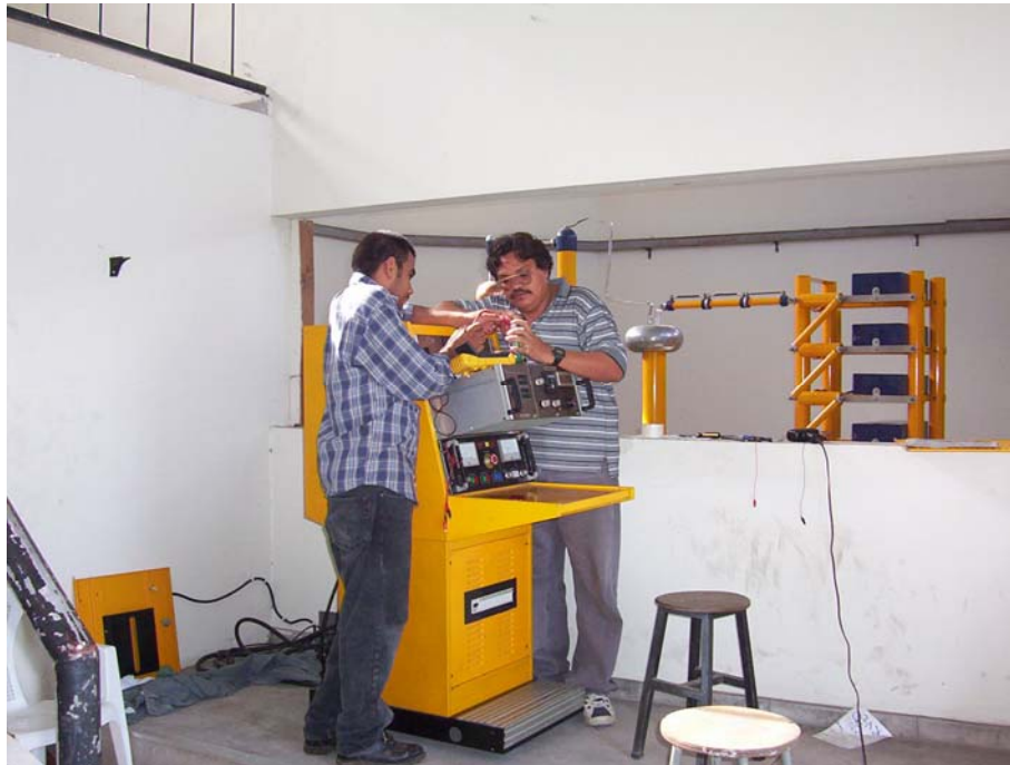
Figura 3.40. Calibración de los potenciómetros
