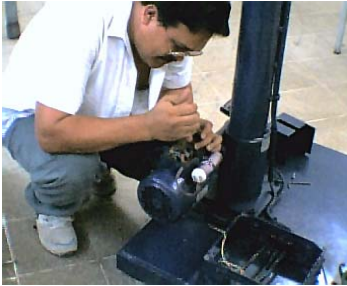
Figura 3.16. Revisión y prueba de los conectores y contactos de los conductores del motor del espinterometro de medición.
