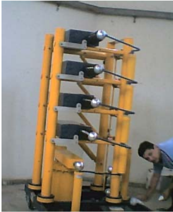
Figura 3.8. Limpieza del modulo de generación.
