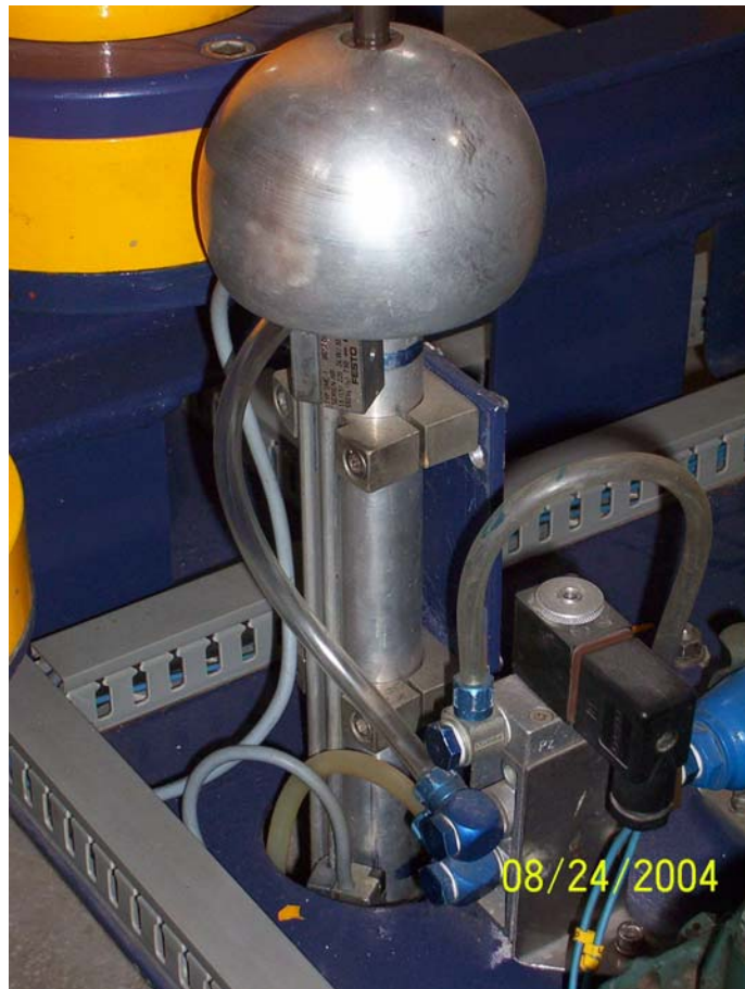
Figura 3.27. Pieza construida del sistema neumático de puesta a tierra con los sensores magnéticos.
