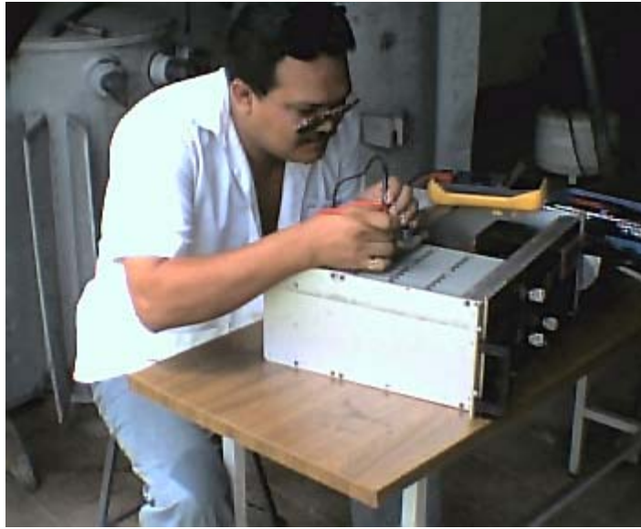
Figura 3.20. Una pequeña revisión y medición de los elementos que contiene la tarjeta, de la unidad de regulación en el panel de control. Se observo que a la tarjeta se le habían realizado modificaciones de elementos electrónicos.
