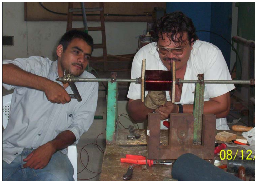
Figura 2. Proceso de construcción del transformador
