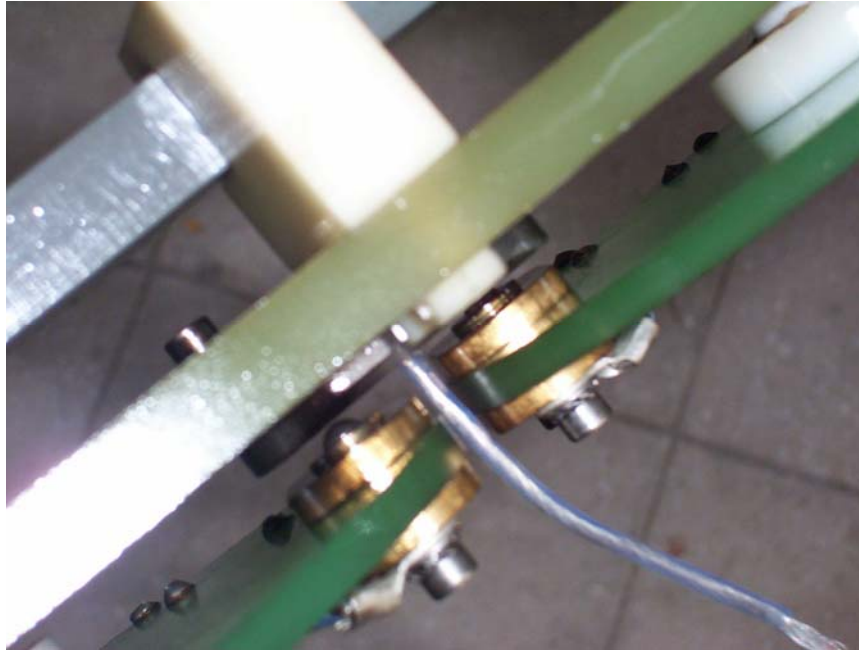
Figura 3.35. Puntos de conexión de las ruedas que no hacen contacto
