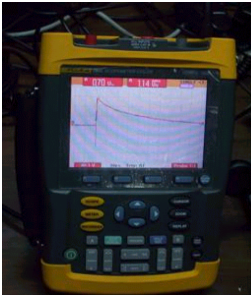
Figura 4.17 Forma de onda estándar del impulso de rayo en el osciloscopio
