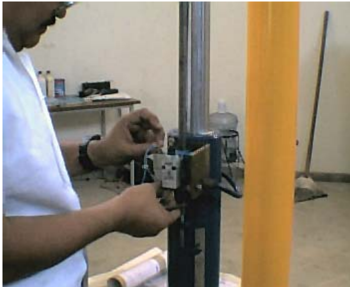
Figura 3.17. Revisión, prueba de los conectores, contactos, terminales de los conductores y calibración de los interruptores de final de carrera del espinterometro de medición.
