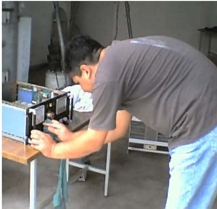
Figura 3.12. Limpieza de unidad de servicio del panel de control.
