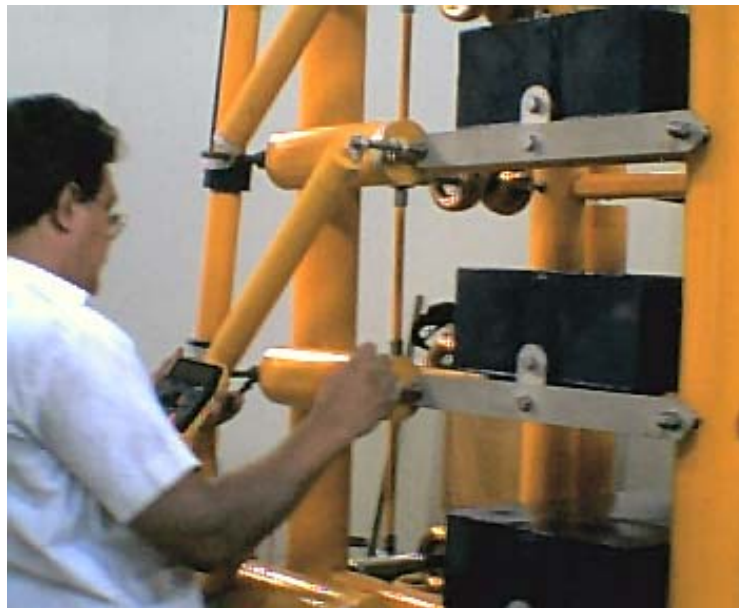
Figura 3.19 Revisión y medición de los elementos resistivos, resistencia de frente, resistencia de cola y resistencia de carga, del generador de impulsos.
