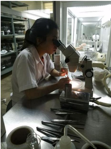
*Anexo E3.* Extracción del meristemo con ayuda de un estereomicroscopio
