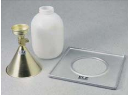
a) Cono de Arena para determinar el peso específico del suelo insitu
