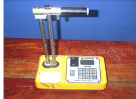
b) Equipo nuclear para control del peso volumetrico de los suelos insitu
