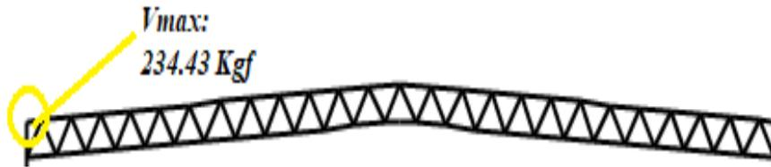
**Figura 5-10:** Punto de cortante máximo en la viga V-G. fuente : Elaboración propia mediante software SAP2000.
