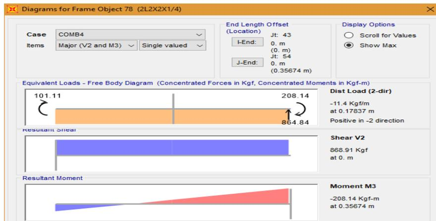
**Figura 5-12:** Diagrama de Momento máximo M3. Fuente: Elaboración propia mediante software SAP2000.
