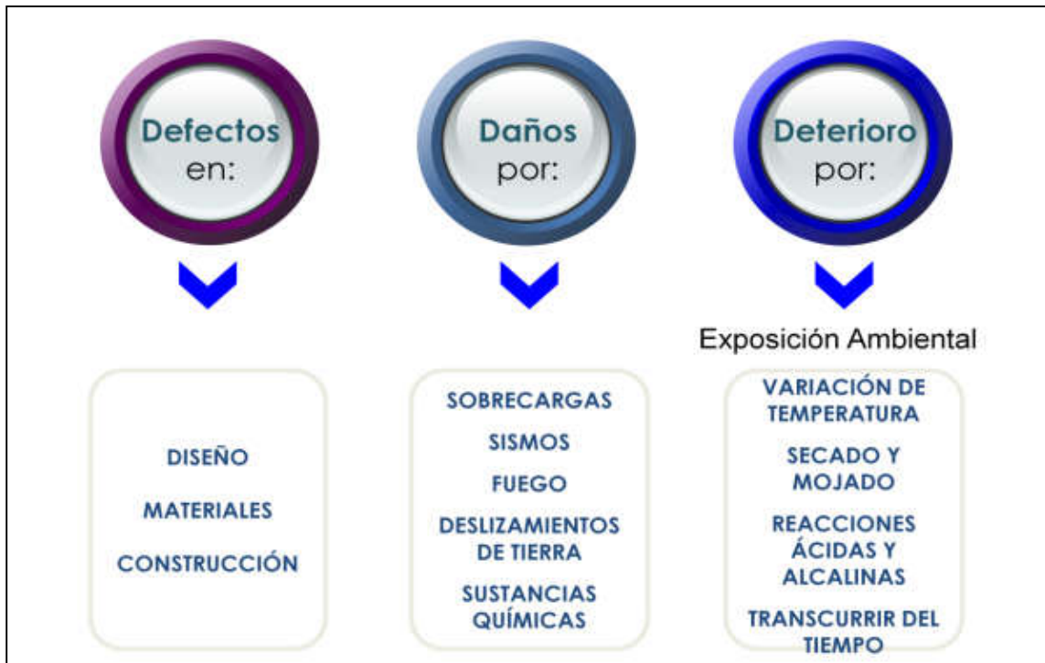
Ilustración 2.1 Clasificación general de patologías en las edificaciones
