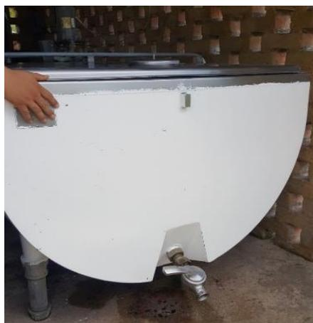
Figura N° 8. Tanque de enfriamiento.
