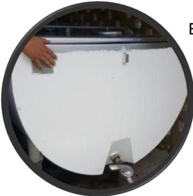
El tanque de enfriamiento debe llevar la leche hasta una temperatura de 4° C. La hélice debe permanecer en agitación durante el período de enfriamiento; una vez alcanzada la temperatura de almacenamiento, la agitación suele ser máximo cada 20 o 30 minutos.
