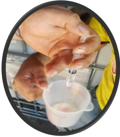
E. Medir 5 ml de NaOH, seguidamente agregar gota a gota a la muestra y agitar constantemente hasta que aparezca un color rosado y se mantenga como mínimo de 20-30 segundos.
