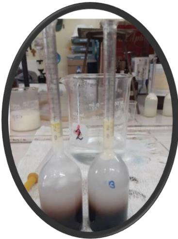
H. Finalmente saque el butirómetro, secar y medir la columna de grasa.
