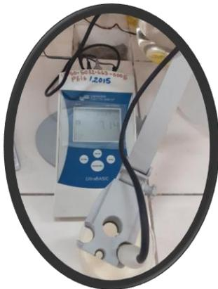
3. Aplicar agua destilada al electrodo y verificar hasta que el pH marcado en el lector se mantenga fijo.
