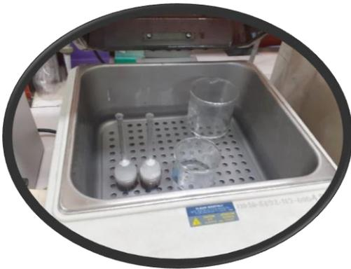
G. Colocar el butirómetro en el baño de agua a 60 °C por 2 a 3 minutos.
