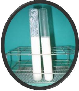
b) Medir y agregar 10 ml de leche con la pipeta en cada tubo de ensayo.
