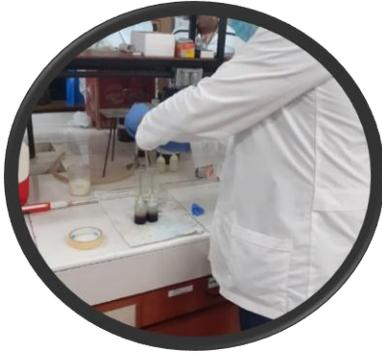
F. Agregar agua a temperatura a 60 °C, hasta que la grasa se aproxime a la penúltima porción graduada del cuello del butirómetro. **Centrifugar nuevamente por 1 min.**
