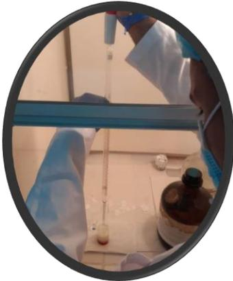
C. Agregar 9 ml de ácido sulfúrico en pequeñas porciones, agitando cada vez.
