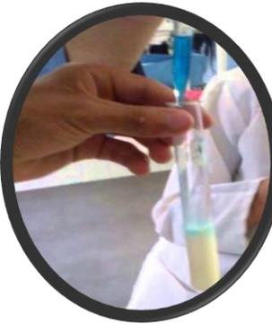
c) Agregar 1 ml de azul de metileno a la muestra de leche en los tubos de ensayo y homogenizar la mezcla.
