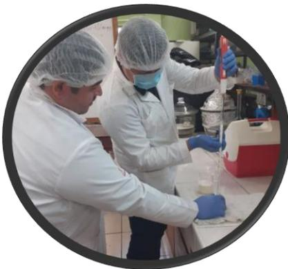
A. Homogenizar bien la muestra y pesar 9 gr directamente en el butirómetro.
