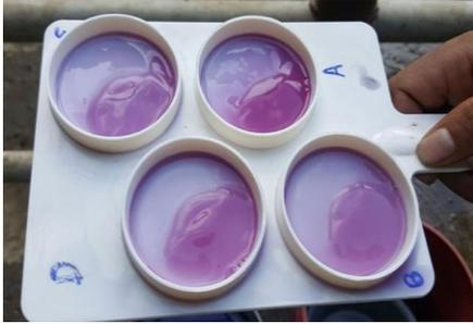
**Positivo evidente (infección seria) = 2:** La mezcla se espesa inmediatamente formando un gel. Al rotar la raqueta este gel se mueve hacia al centro, y al detener la rotación se esparce en el fondo del recipiente.
