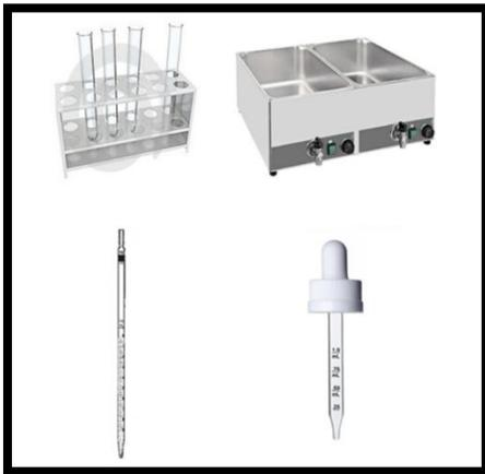
✓ Instrumentos: Gradilla, tubos de ensayo, baño maría, pipeta de 10 ml y un gotero de 1 ml o una pera de goma.
