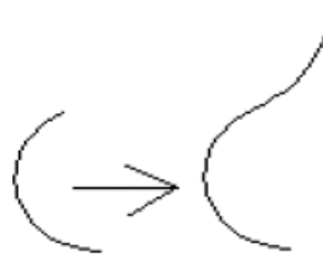
Figura A.1.10 Representación de resultado de arcos generados por medio del comando Reverse or Compound
