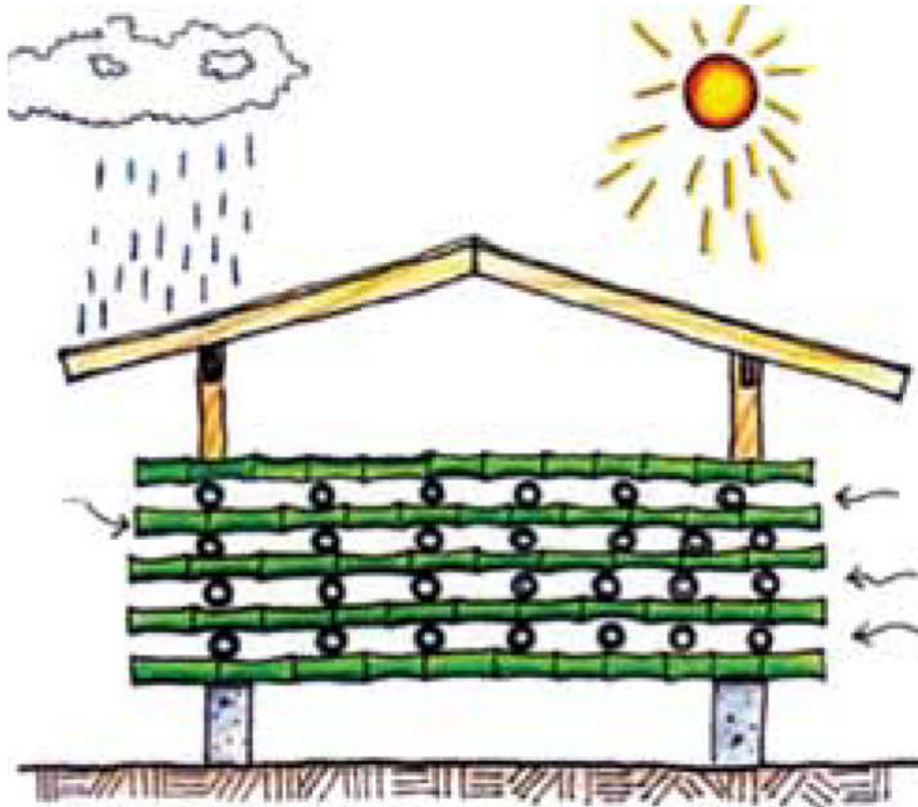
Figura 24 Esquema de Secado de Bambú.
