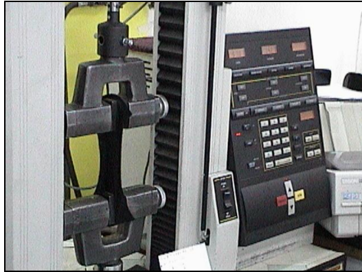
Fig. 23 Espécimen colocado entre las mordazas de la máquina de ensayo.
