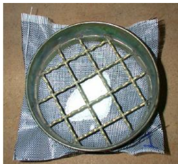
Fig. 30 Geotextil preparado para ser ensayado
