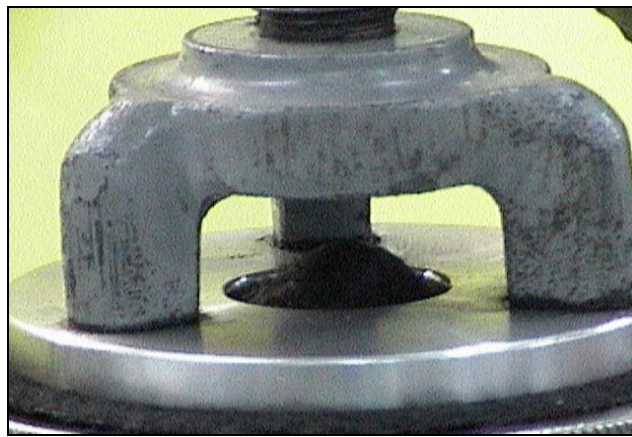
Fig. 35 Especimen deformándose mientras se infla el diafragma.
