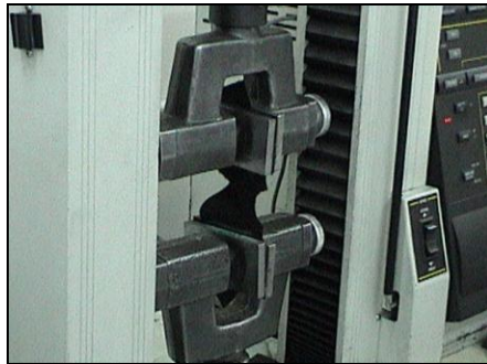
Fig. 27 Momento de realización del ensayo de resistencia al desgarre.
