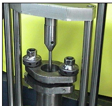
Fig. 31 Barra de acero adaptada a la máquina de ensayo universal
