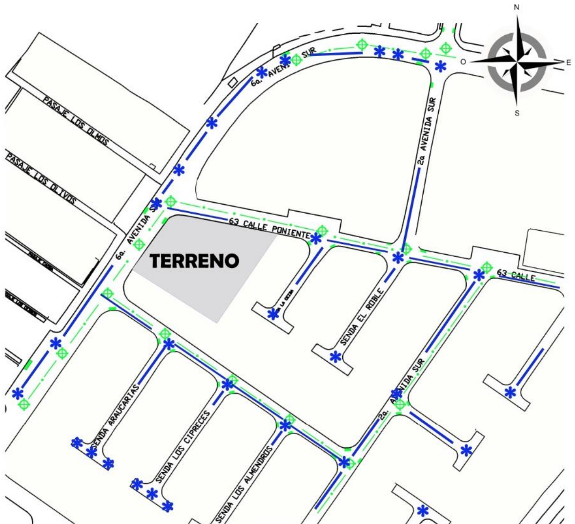
Imagen 50: Sistema de drenaje de aguas lluvias y aguas negras.
