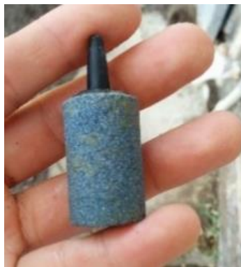
Figura A3. Sistema de aireación (a. Piedra filtro, b. manguera distribución de aire).
