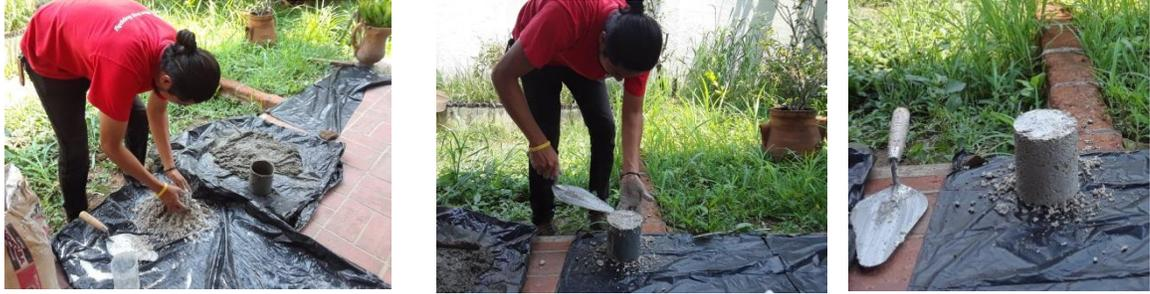
**Ilustración 31. Elaboración de Prueba de Mortero.**
