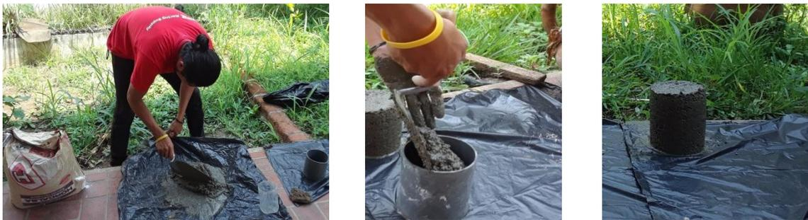
**Ilustración 32. Elaboración de Prueba de Mortero.**
