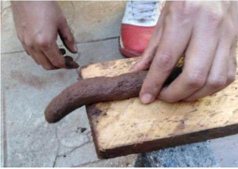
**Ilustración 24. Prueba insitu de rollito**
