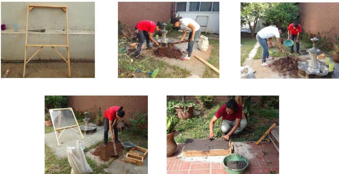
Ilustración 26. Proceso de Elaboración de Above Sismo Resistente.
