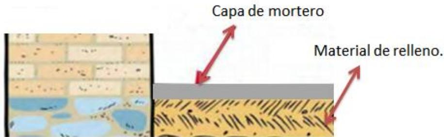
Ilustración 45. Piso con mortero de arena-cemento.
