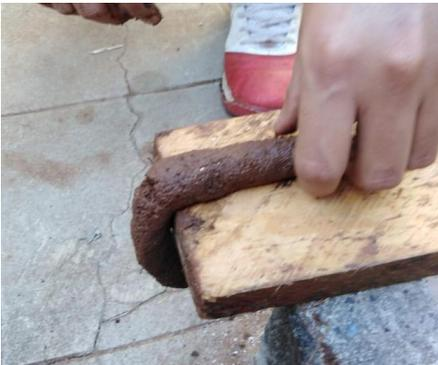
**Ilustración 25. Prueba insitu Rollito**
