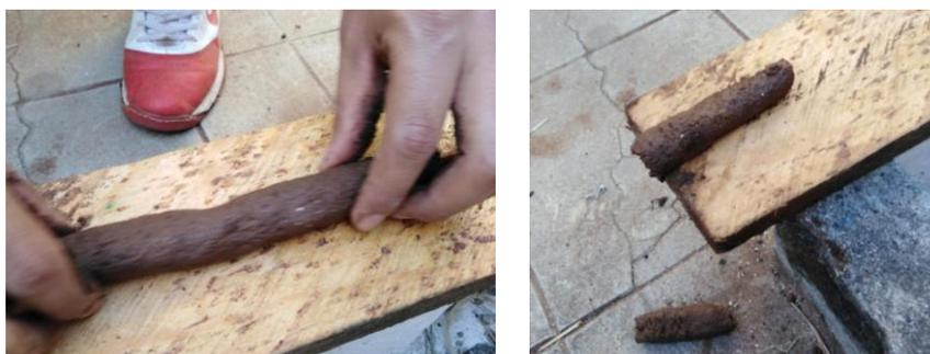
Ilustración 23. Prueba insitu de rollito.
