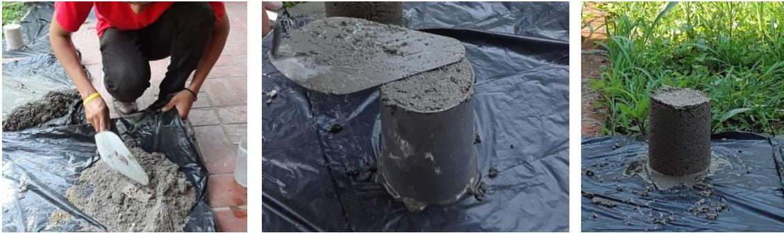
**Ilustración 33. Elaboración de Prueba Mortero de ceniza.**
