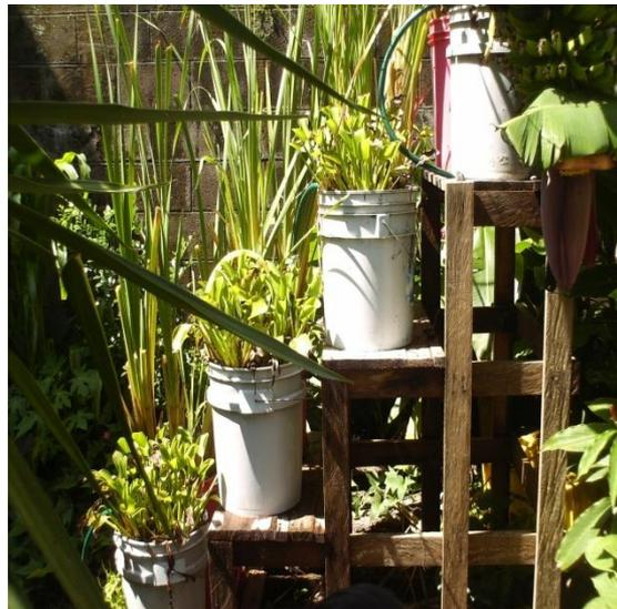
Figura Nº 20 Vista lateral de microhumedales artificiales con plantas de Tule y Jacinto de Agua.
