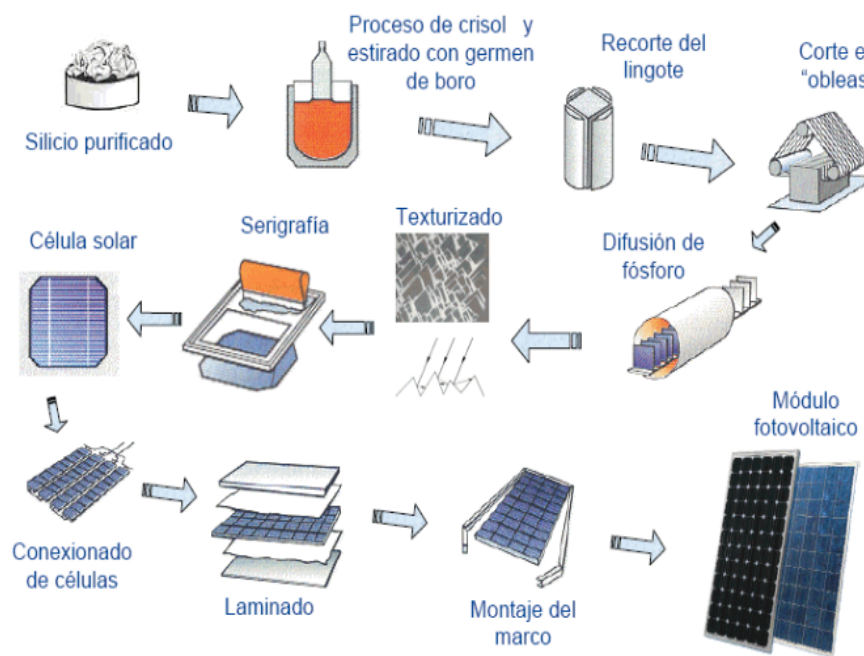
Figura 3.25: Proceso general de un módulo fotovoltaico.
