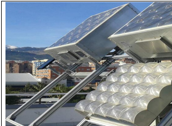
Figura 3.21: Sistema de concentracion pro refracción.
