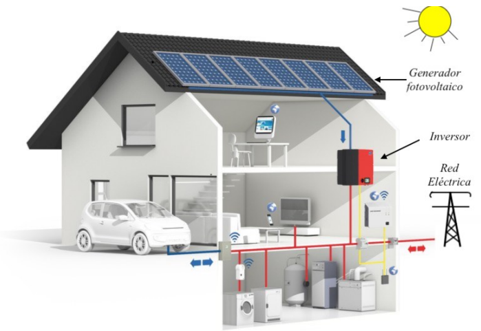
Figura 4.13: Sistema de generación con 1 entrada de MPPT.
