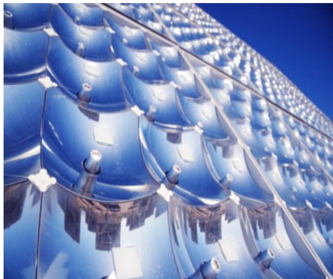
Figura 3.23: Sistema de concentracion reflectivo.
