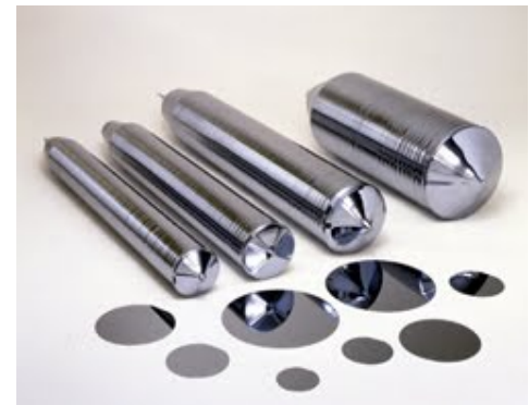
Figura 3.29. Lingotes listos para cortarse.
