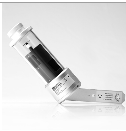
Figura 2.41: Heliógrafo-sensor de duración de insolación.
