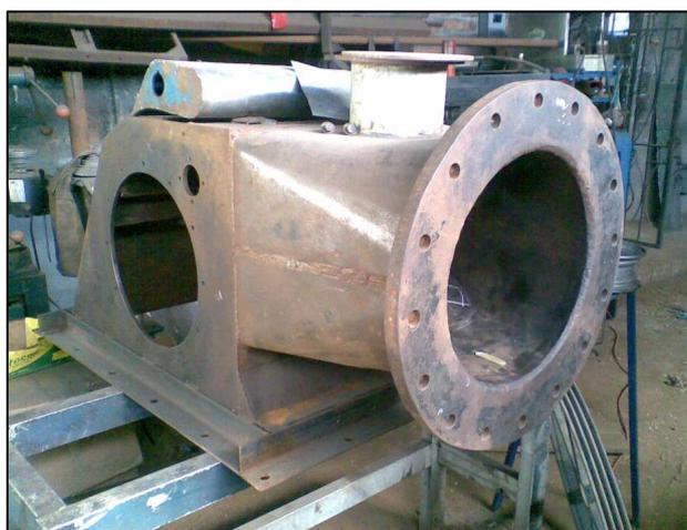
Figura 3.12 Turbina de tipo cruzado Michell – Banki y alabe de control en construcción.
