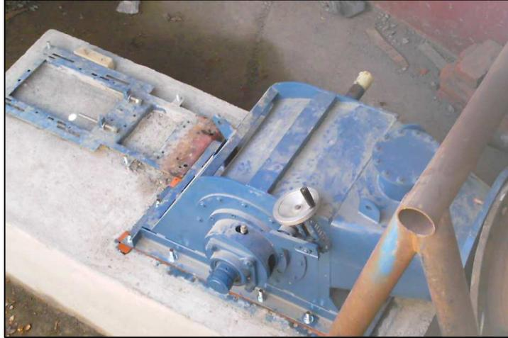
Figura 3.15 Base para montaje del generador marca Magnapuls.
