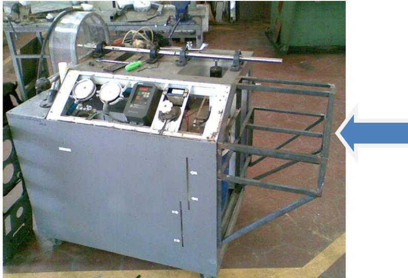
Figura 4.14 Ensamblaje de estructura de soporte del alternador.
