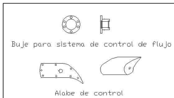
Figura 3.11. Buje para el sistema de control de flujo y alabe de control.
