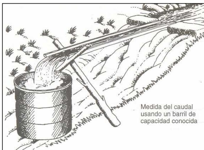
Figura 2.6.- Usando el método del recipiente
