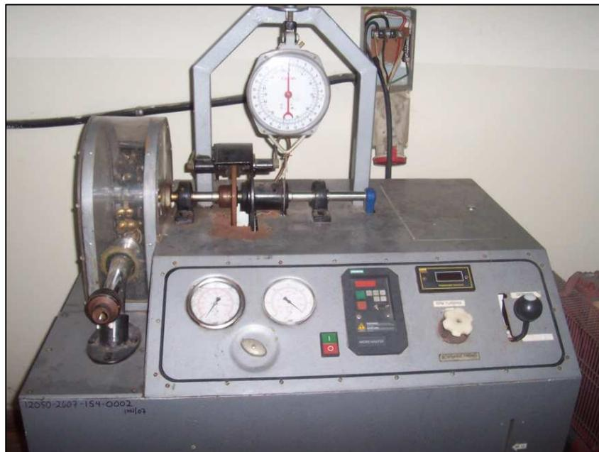
Figura 4.1. Banco de pruebas de turbinas Pelton
