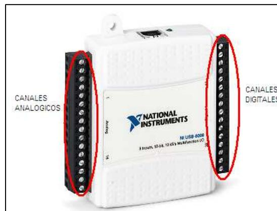
Figura A. 2 Tarjeta de adquisición de datos, NI USB-6008 de National Instrument.
