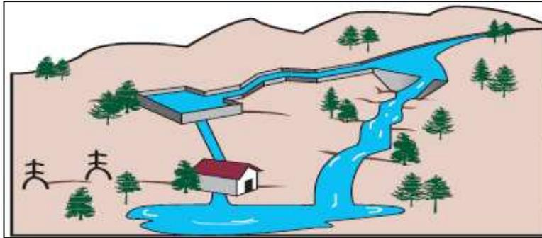
Figura 1.2 Central hidroeléctrica de tipo fluyente
