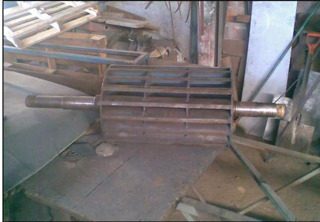
Figura 3.13. Eje de la turbina Michell – Banki.
