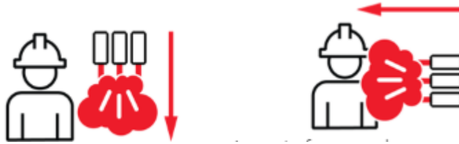
Figura 24. Dirección de plasma de arco con respecto a los electrodos y el trabajador.
