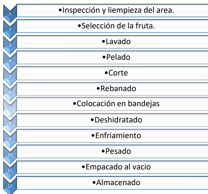
Figura 1 Proceso de deshidratación de la fruta. Fuente: Infoagro.
